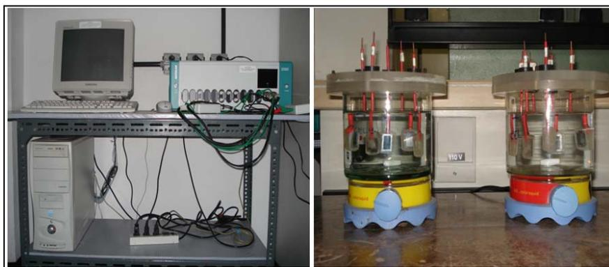
Figura 3.1: Equipamento AUTOLAB PGSTAT 30 e montagem experimental dos ensaios eletroquímicos.
