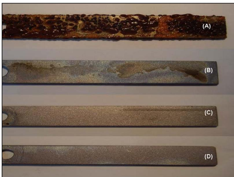
Figura 4.3.1: Corpos-de-prova após ensaio de perda de massa, sendo: (A) Solução 02 - 100 ppm Cl<sup>-</sup> + 50 ppm HEDP, (B) Solução 10- 100 ppm Cl<sup>-</sup> + 50 ppm HEDP + 5 ppm Ca(II), (C) Solução 12- 100 ppm Cl<sup>-</sup> + 50 ppm HEDP + 30 ppm Zn(II) + 5 ppm Ca(II), (D) Solução 19- 100 ppm Cl<sup>-</sup> + 20 ppm HEDP+ 10 ppm Zn(II).
