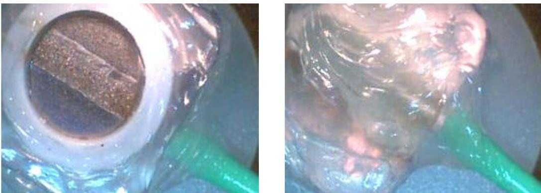
Figura III.4 – Preparação do corpo-de-prova para polarização e impedância
