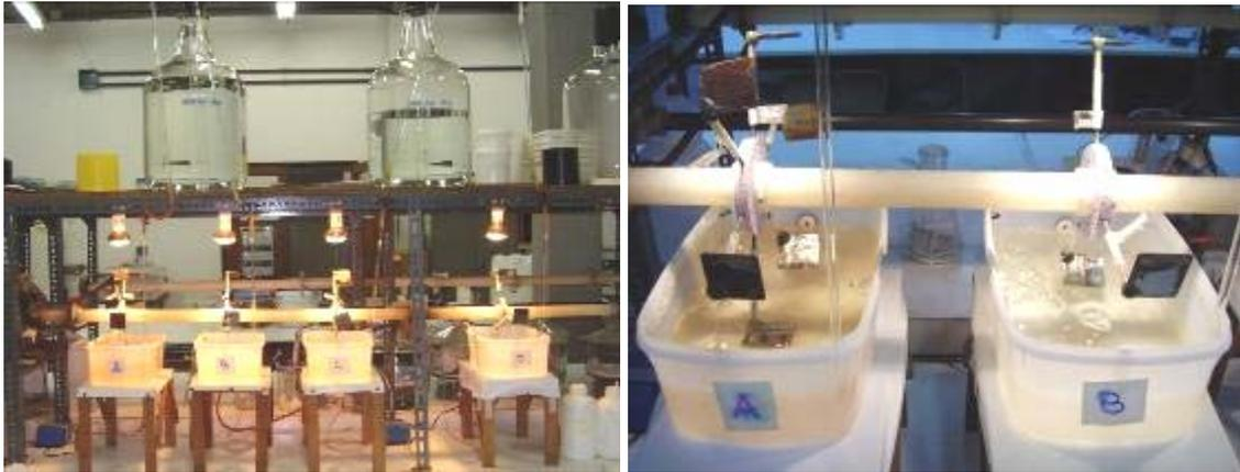
Figura III.6 – Montagem do ensaio e imersão e emersão alternadas.
