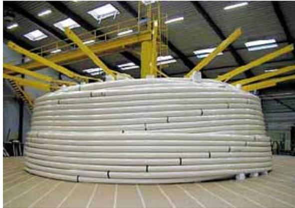
**Figura 12:** PVDF utilizado em dutos para sistemas offshore (SOLVAY, 2004).
