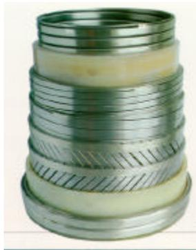
**Figura 8:** Linha flexível do tipo *rough bore* (SANTOS, 2005).
