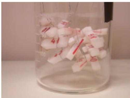
**Figura 25:** Corpos de prova de PVDF amarrados para ensaio de ganho de massa antes de ser preenchido com um dos fluidos.
