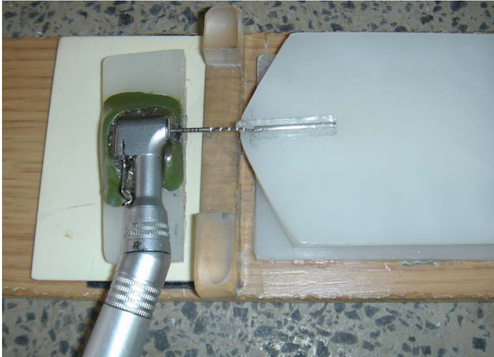
Figura 32 – Dispositivo de avaliação de eficiência de corte – Lima montada no contra-ângulo, apoiada no capilar de vidro.
