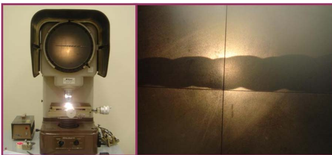
Figura 20 - Projetor de Perfil (à esquerda). Imagem do instrumento na tela do aparelho (à direita).
