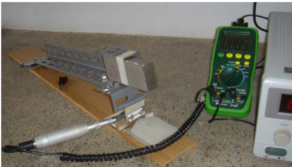
Figura 34 – Dispositivo de avaliação de eficiência de corte ligado ao multímetro e à fonte.
