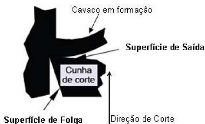
Figura 14 – Cunha de corte de uma ferramenta.
