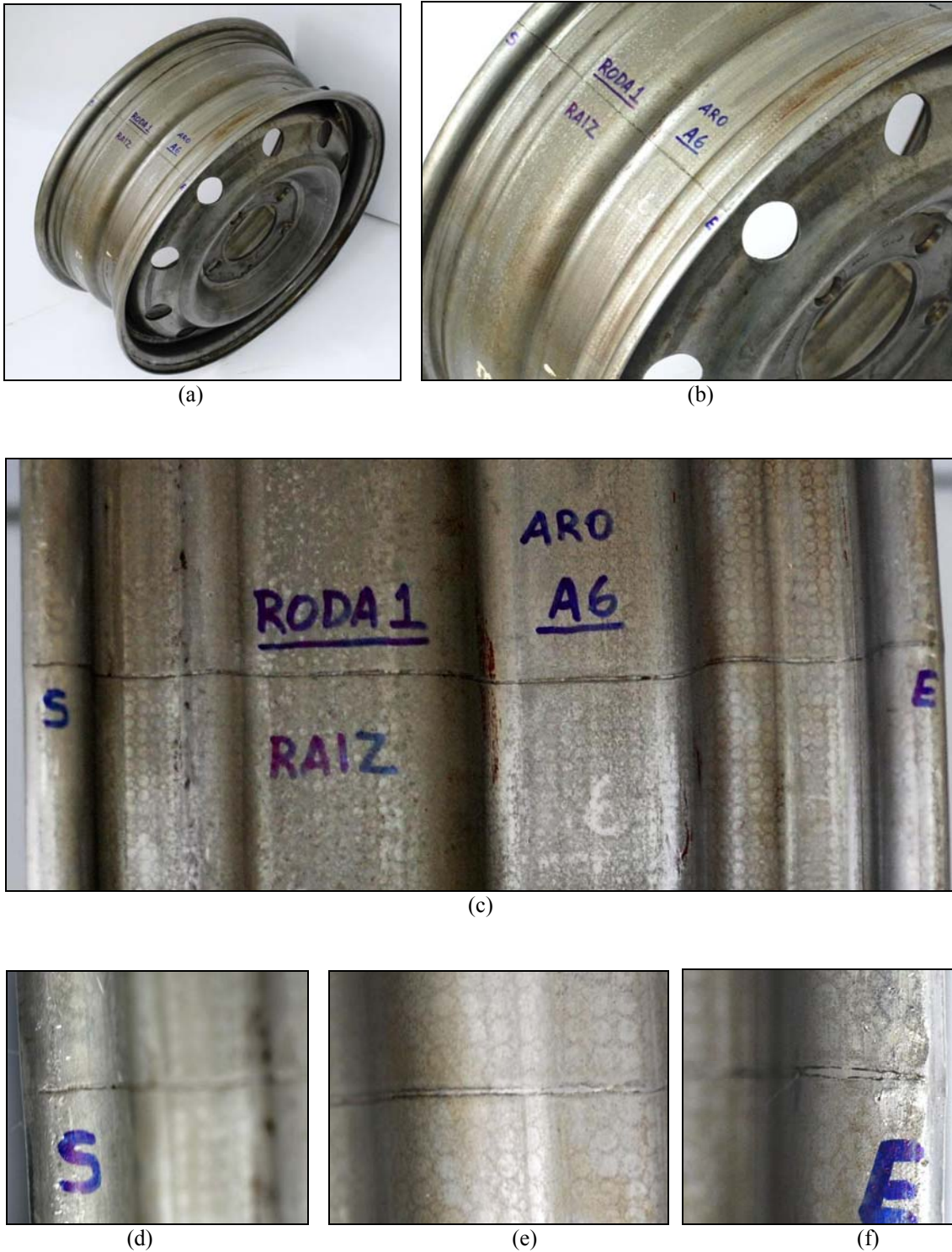
Figura 132 – Roda 1 – 1.566.000 ciclos em fadiga (600.000 a ciclagem mínima). Detalhe “a” mostrando o modelo da Roda 1. Detalhe “b” mostra a raiz da solda LASER voltada para superfície externa do aro. Detalhe “c” mostra todo perfil do aro. Detalhes “d”, “e” e “f” evidenciam a saída, região de maior conformação sem trinca e entrada do feixe LASER, respectivamente.
