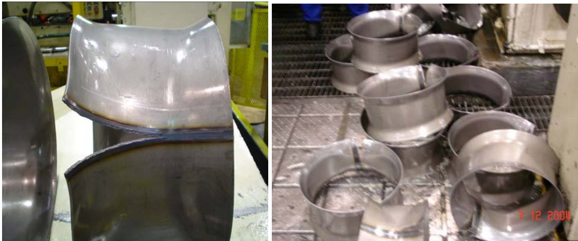
Figura 59 – Falha típica do aro na “operação V”. (foto gentilmente cedida pela Borlem).
