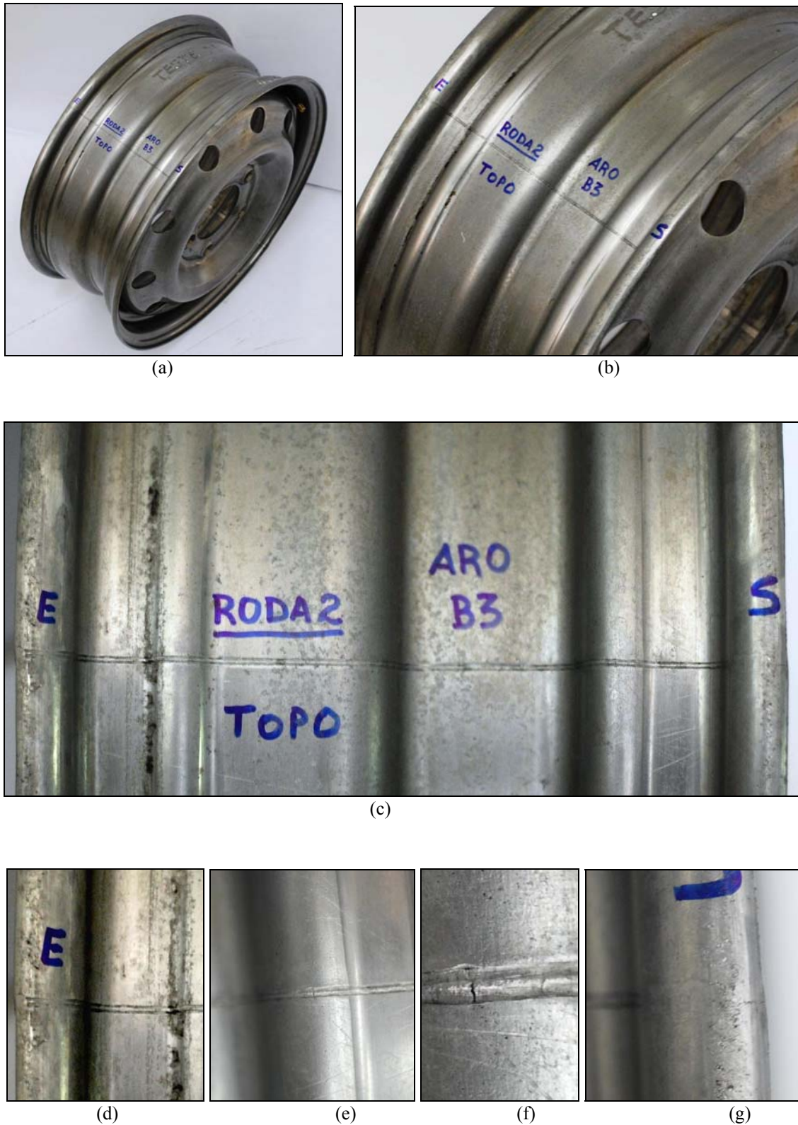
Figura 133 – Roda 2 – 1.211.000 ciclos em fadiga (600.000 a ciclagem mínima). Detalhe “a” mostrando o modelo da Roda 2. Detalhe “b” mostra o topo da solda LASER voltado para superfície externa do aro. Detalhe “c” mostra todo perfil do aro. Detalhe “d” entrada do feixe, “e” e “f” evidenciam a presença de leve microtrinca sob cordão e “g” saída do feixe com preenchimento de metal de solda pelo processo TIG.
