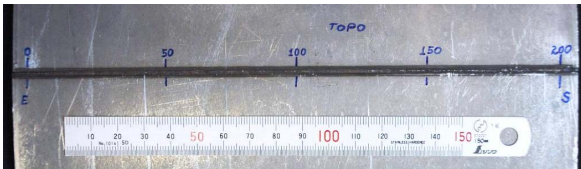
Figura 72 – Aspecto da entrada e saída do feixe LASER, de uma peça posicionada no centro das três que foram soldadas.
