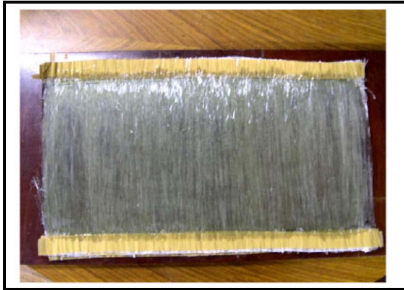
Figura 3. 4 – Laminado unidirecional resultante do processo de laminação manual realizado por ALBUQUERQUE [1].
