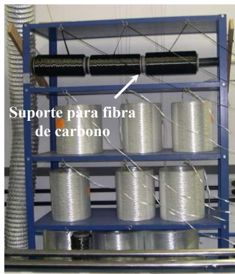
**Figura 36** – Porta fibras de carbono construído.
