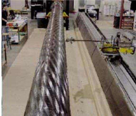
**Figura 20** – Enrolamento filamental do *riser* rígido produzido (Storhaug *et al*, 2001).
