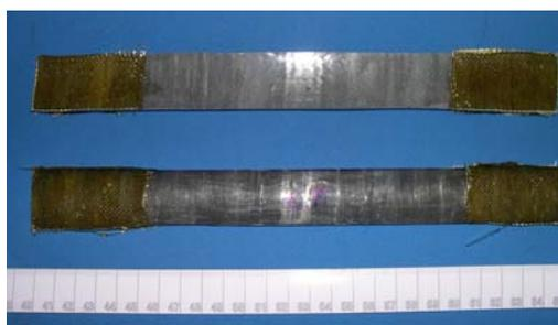
**Figura 39** - Geometria dos corpos de prova usados no ensaio de tração.
