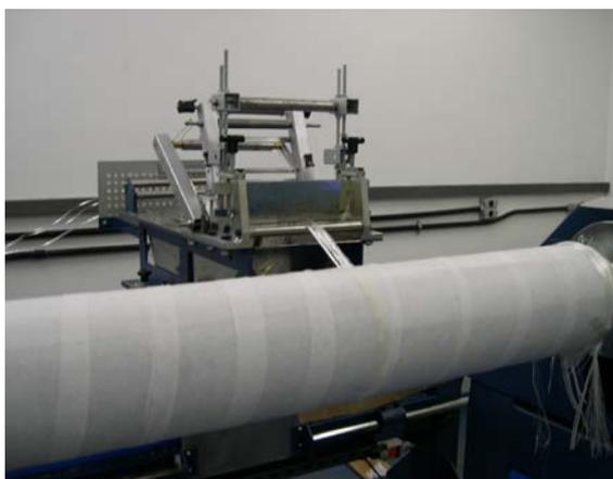
**Figura 46** – Camada de véu colocada sobre o mandril.
