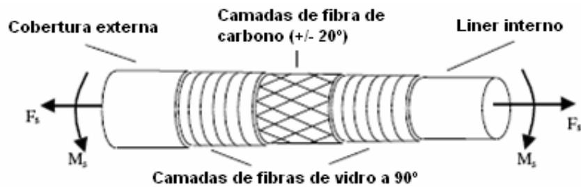
**Figura 23** – Configuração do *riser* composto (Meniconi *et al*, 2001).
