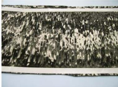
**Figura 28** - Camada de fibra de carbono.
