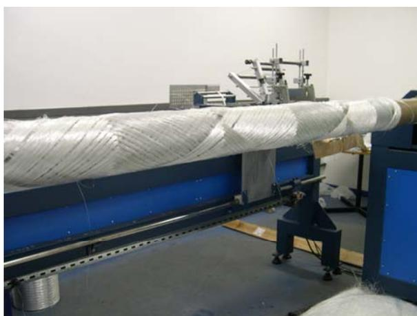
**Figura 53** – Camada helicoidal a  $\pm 45^\circ$  sem resina.
