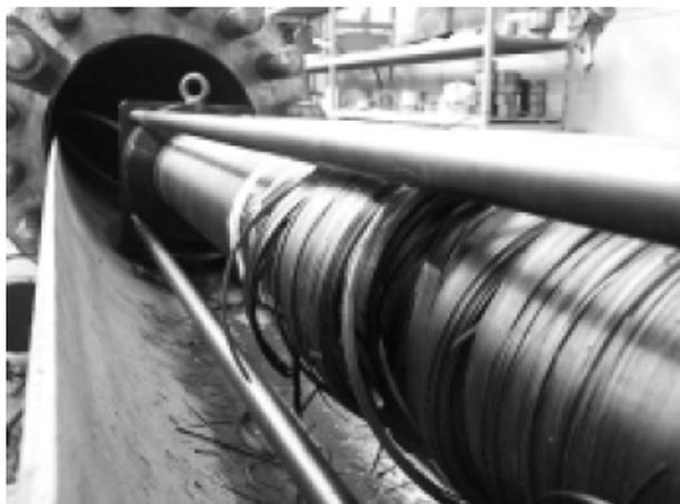
**Figura 22** – Tubo híbrido após o teste de explosão a temperatura ambiente (Guesnon *et al.*, 2002).
