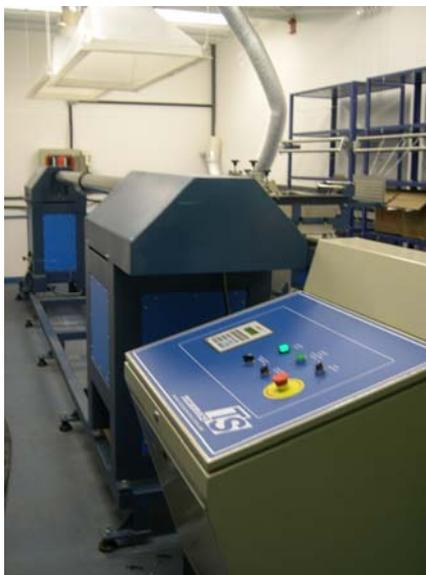
**Figura 34** – Máquina de enrolamento filamantar utilizada na produção dos tubos.
