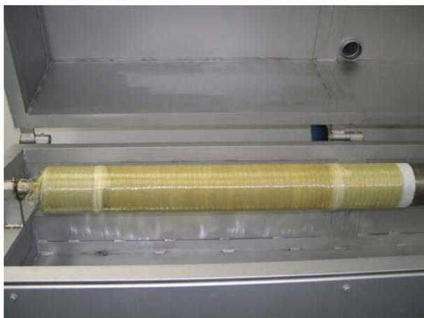
**Figura 47** – Foto do tubo produzido após a cura.
