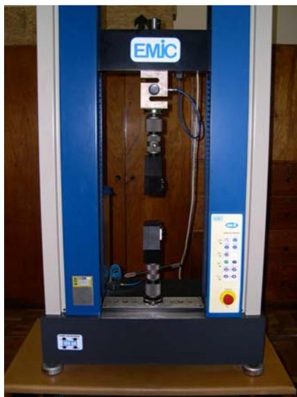
**Figura 31** – Máquina EMIC utilizada nos testes de tração.
