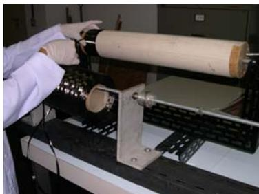
Inicialmente o *roving* de fibra é enrolado sobre o cilindro a um ângulo de 90° com o seu eixo;
