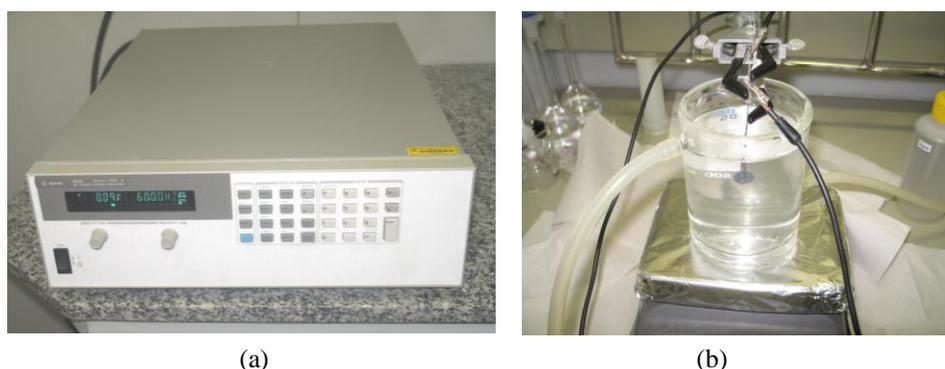
Fig. 3.1 - Ilustração do aparato utilizado para realização do processo de oxidação anódica a microarco.
