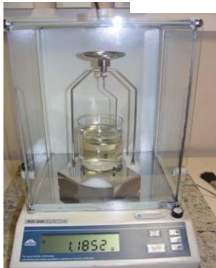
Figura 3.14- Determinação da massa úmida
