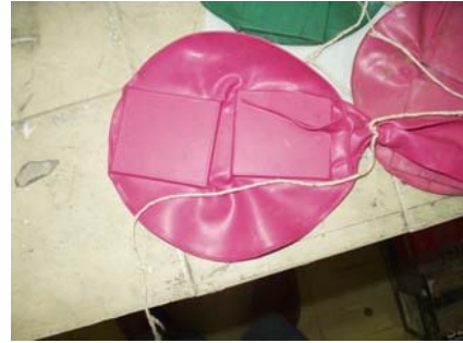
Figura 3.7- Selagem a vácuo do compactado uniaxial em molde de elastômero
