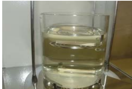
Figura 3.13-Determinação da massa imersa
