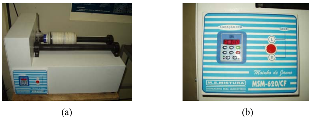
Figura 3.1 – Moinho de bolas (a); Detalhe do painel (b)
