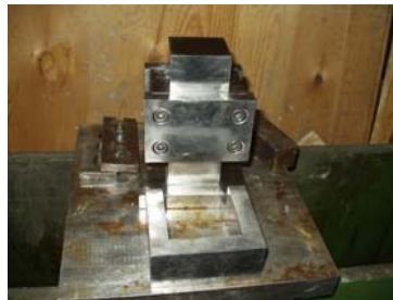
Figura 3.5 – Matriz (molde) de aço temperado para prensagem uniaxial
