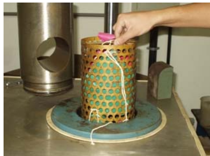
Figura 3.8- Imersão da placa compactada(selado a vácuo em elastômero) no líquido para prensagem isostática.
