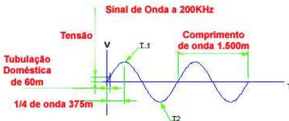
**Fig. 13** - Representação do comprimento de onda gerado pelo equipamento eletromagnético na tubulação. [11]
