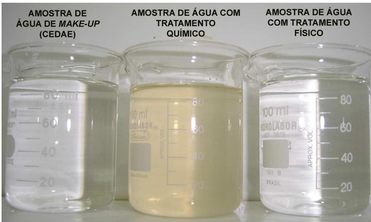
**Fig 49** – Comparação visual entre as amostras de água de Make-up (CEDAE), água com tratamento químico convencional e a água sob o efeito de campo eletromagnético do equipamento instalado no sistema.
