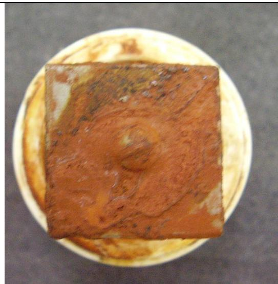
**Fig 43** – Exemplo de corpo-de-prova não conectado eletricamente à tubulação em bujão de PVC
