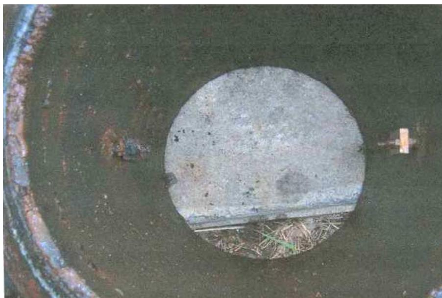
**Fig 27** - Verificação visual na posição nº 03 onde encontram-se o coupon de perda de massa à esquerda e o coupon de incrustação à direita na tubulação após três meses de utilização. [14]
