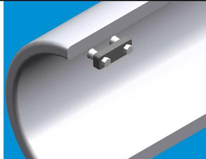
**Fig 37** – Esquema de montagem dos corpos-de-prova apontando o detalhe da fixação no tubo, proposto pelo fabricante
