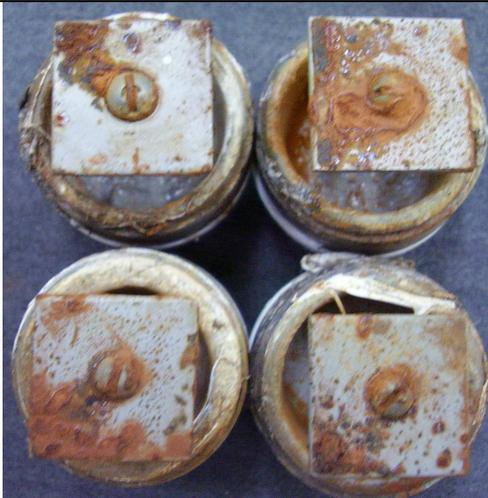
**Fig 44** – Corpo-de-prova em bujões em aço (conectados eletricamente ao tubo)
