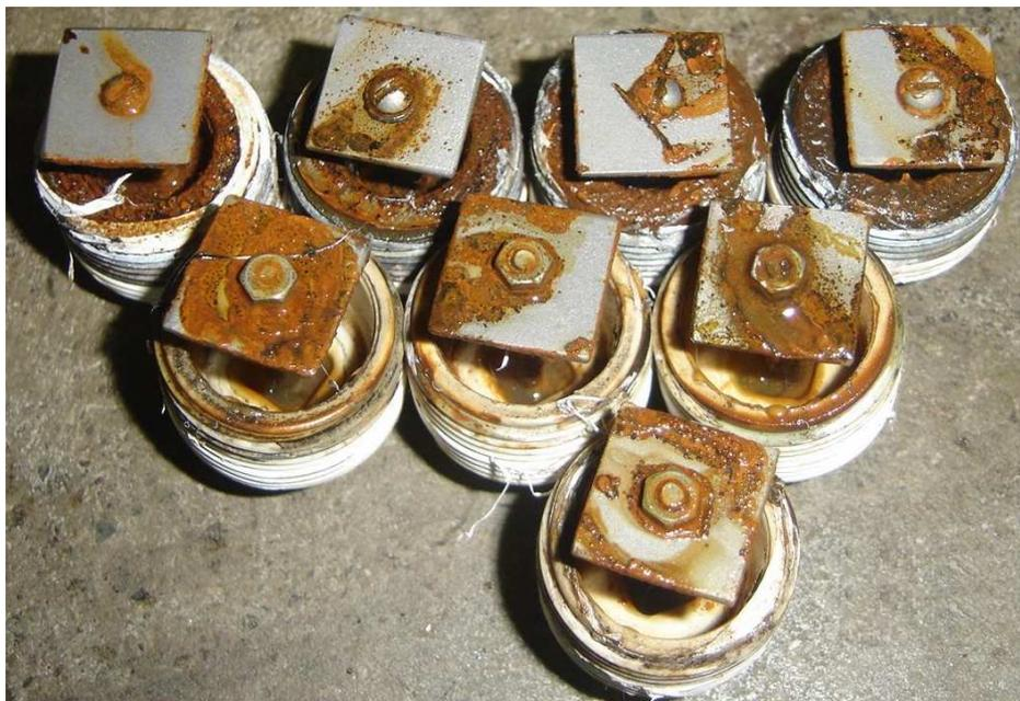
**Fig 46** – Experimento 03 - Quatro corpos-de-prova posicionados acima da figura estão em bujões de aço e os quatro posicionados abaixo em bujões de PVC
