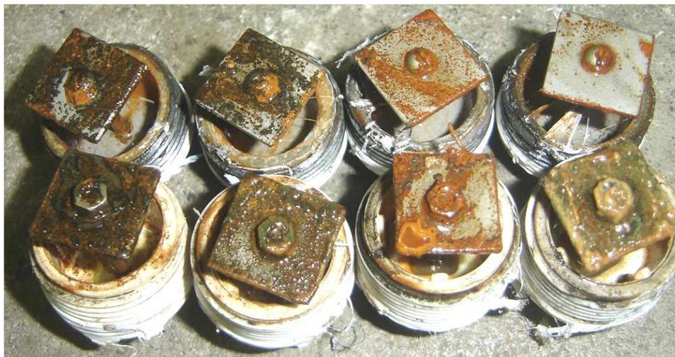
**Fig 47** – Experimento 04 - Quatro corpos-de-prova posicionados acima da figura estão fixados em bujões de aço e os quatro posicionados abaixo em bujões de PVC
