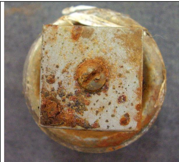
**Fig 42** – Exemplo de corpo-de-prova conectado eletricamente à tubulação em bujão de aço carbono
