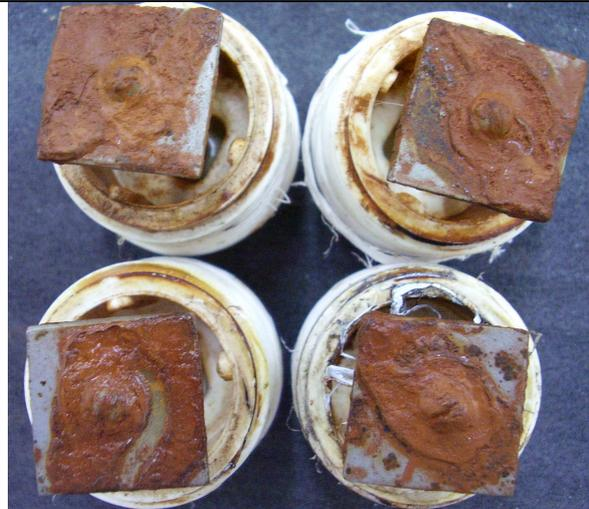
**Fig 45** – Corpo-de-prova em bujões PVC (não conectados eletricamente ao tubo)
