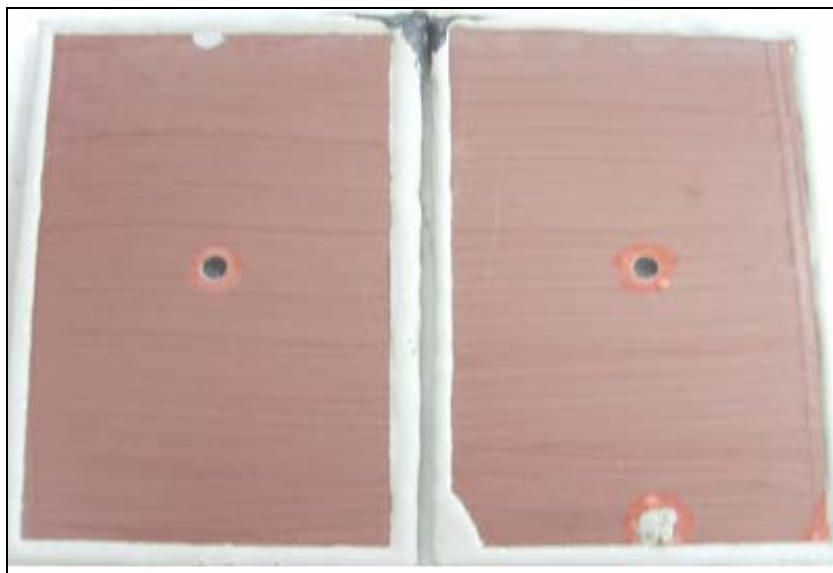
Figura 36: Aspecto visual da tinta com \Lambda 0,83 com alumínio retirado após três meses no ensaio de descolamento catódico. Amostras em duplicata.
