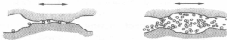
Figura 3 - Esquema de desgaste corrosivo (BUSCHAN e GUPTA, 1997).
