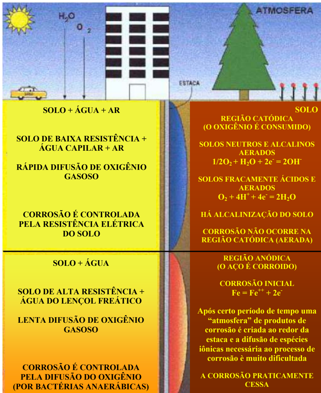
Figura 2.13: Características básicas pertinentes ao processo de corrosão do aço carbono no solo. As primeiras camadas de solo contêm oxigênio cuja concentração decresce com a profundidade. A corrosão do aço enterrado acontece através do mecanismo eletroquímico, isto é, reações anódica e catódica acontecendo em locais distintos do mesmo metal (PANNONI, 2002).
