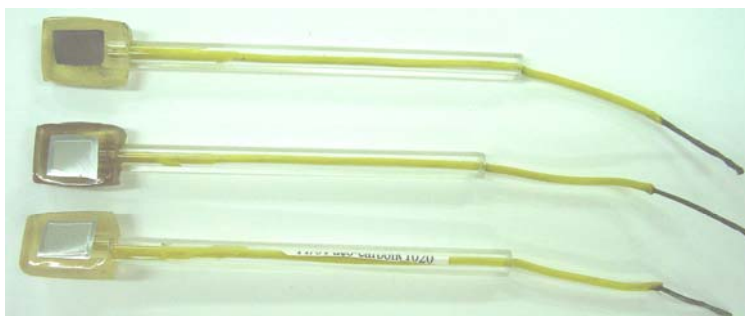
Figura 3.3: Corpos-de-prova em aço-carbono 1020, embutidos em resina e lixados até a lixa nº. 600, com áreas superficiais de aproximadamente 1\text{cm}^2 .
