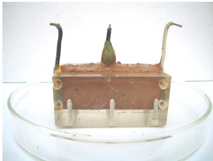
Figura 3.6: Solo saturado em água destilada e compactado na soil box A .
