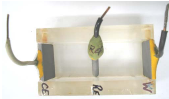
Figura 3.5: Soil box A , onde foram realizados os ensaios com três eletrodos de aço-carbono em solo saturado em água destilada.
