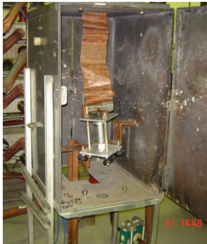
Figura 24 – Detalhe do varistor conectado entre o tubo e a placa de alumínio no prendedor confeccionado em alumínio.
