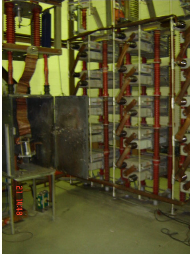
Figura 31 – Detalhe do arranjo de ensaio utilizado para a medição da tensão residual. Laboratório de Impulso de Corrente (AT4) da DVLA – CEPEL.
