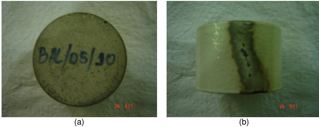
Figura 71 – Detalhe da parte superior do varistor 10 (a), e detalhe da descarga pela superfície lateral do varistor 10 (b).
