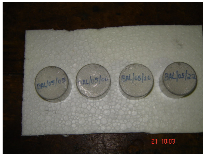
Figura 47 – A Figura mostra os varistores 05, 06, 16 e 22 antes do ensaio de degradação por ciclos de descargas atmosféricas.
