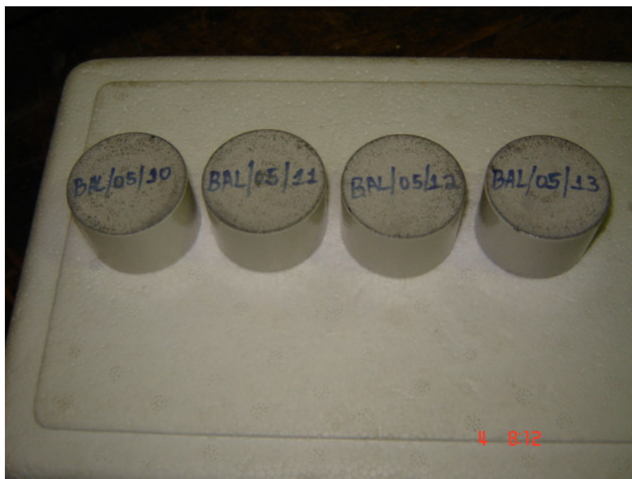
Figura 70 – A Figura mostra os varistores 10, 11, 12 e 13 antes do ensaio de degradação.
