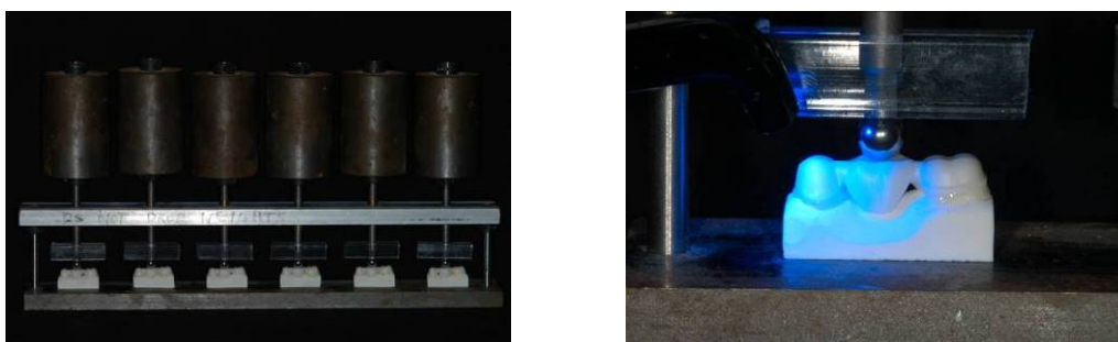
Figura 18 - Aparato usado para manter a mesma carga na cimentação adesiva.
