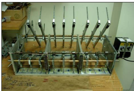
Figura 19 - Máquina de testes de fadiga cíclica.
