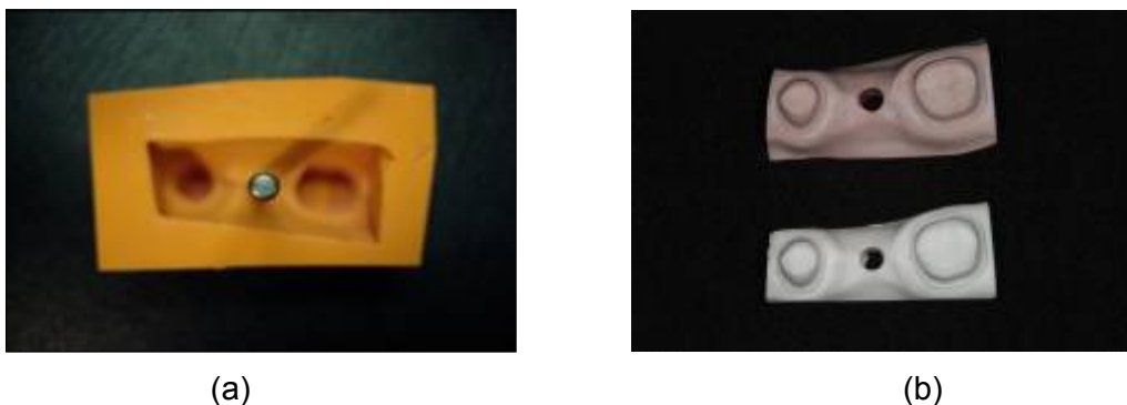
Figura 11 - (a) Molde mostrando o pino de estabilização e (b) vista oclusal do modelo mestre de gesso e do modelo em resina epóxica.
