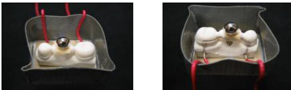
Figura 20 - Preparo dos modelos para o teste de fadiga cíclica.
