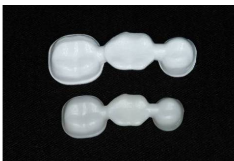
Figura 25 - Subestruturas de zircônia mostrando a contração das próteses após a sinterização.
