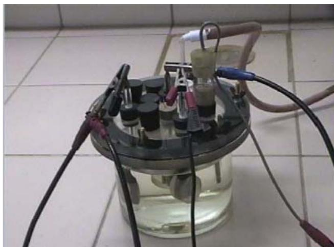
**Figura 3.4.2** Célula eletroquímica convencional para ensaios de voltametria.
