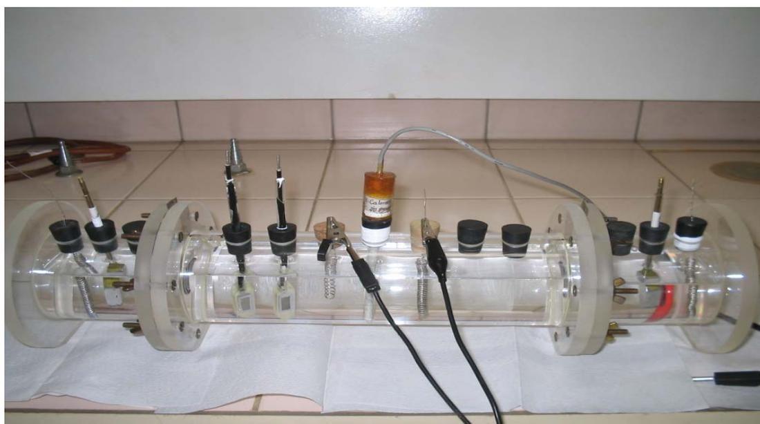
**Figura 3.4.1** Célula eletroquímica cilíndrica para ensaios de voltametria.
