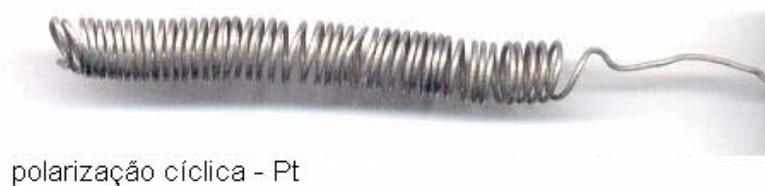
**Figura 4.18** Eletrodo de Pt após polarização cíclica em água ácida sintética
