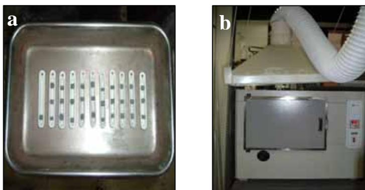
Figura III.4 - Eliminação da uréia: (a) amostras em navículas cerâmicas; (b) estufa.
