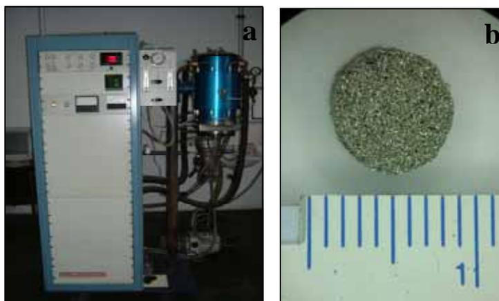
Figura III.5 - Forno a vácuo para a sinterização (a); amostra sinterizada (b).
