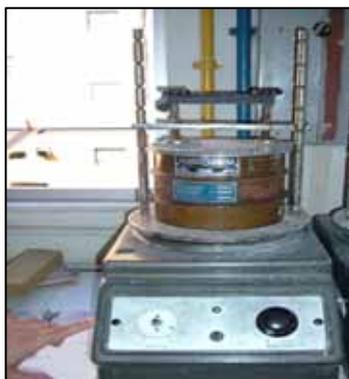
Figura III.2 - Vibrador de peneiras.
