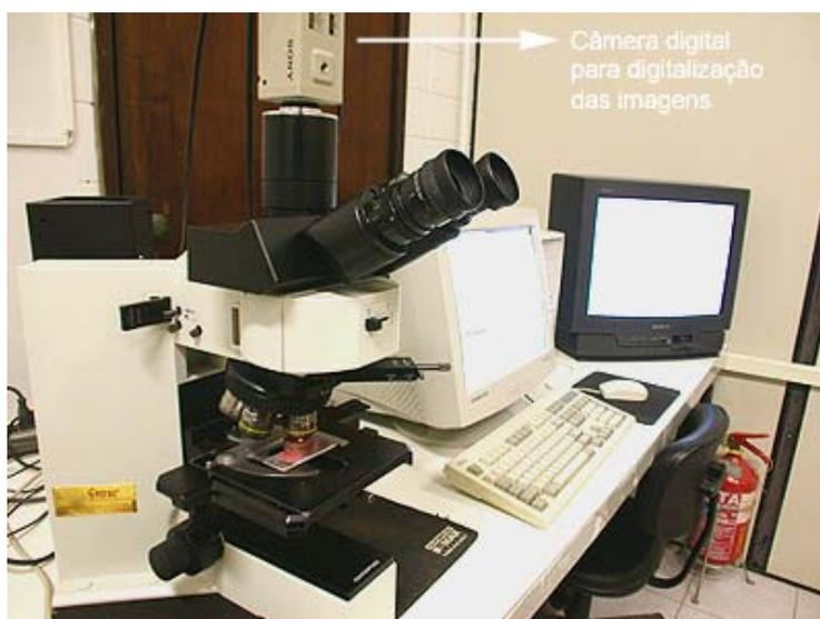
Figura 44: Sistema de aquisição das imagens em microscópio ótico.
