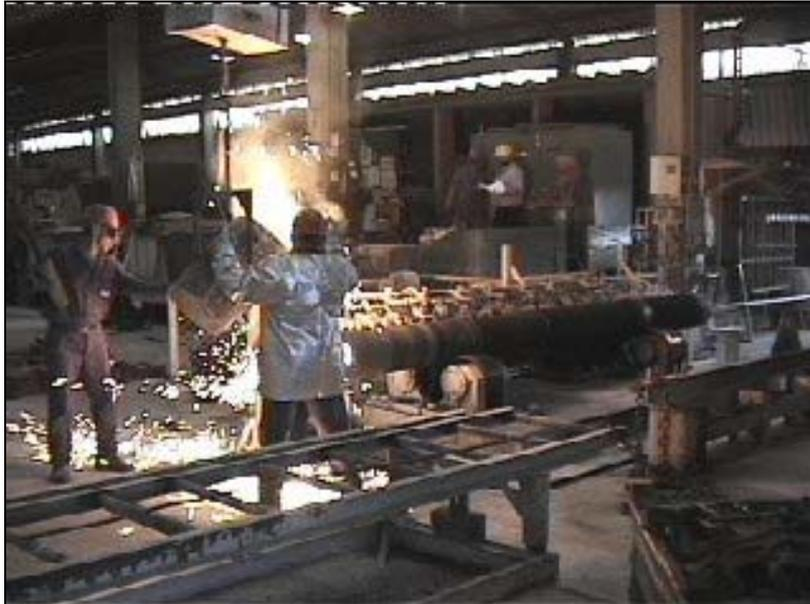
Figura 41: Momento do vazamento da carga na coquilha.
