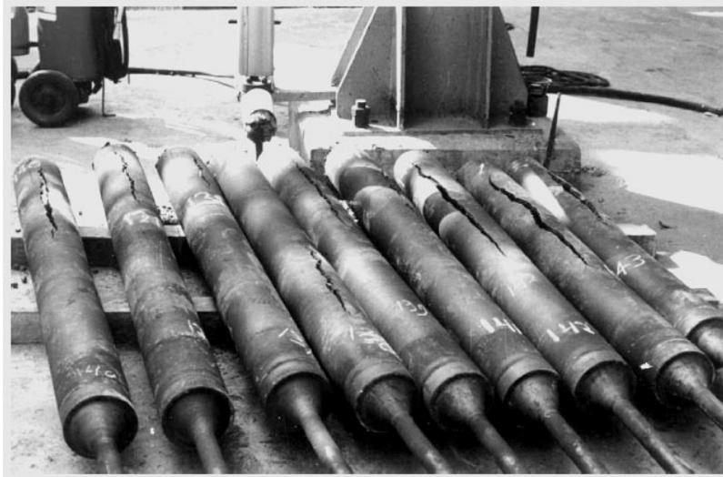
Figura 40: Vista geral de tubos de fornos de reforma rompidos em serviço e analisados em trabalho de Ray [42].
