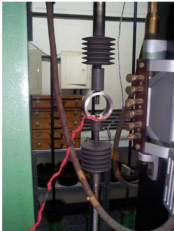
Figura 50: Célula de carga utilizada para calibração do equipamento de ensaios.
