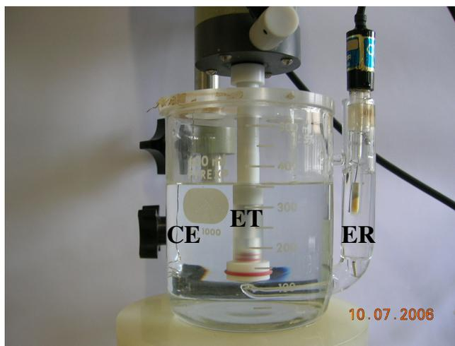
Figura IV.1 – A célula de vidro empregada nas voltametrias. CE = contra-eletrodo; ET = eletrodo de trabalho e ER = eletrodo de referência.
