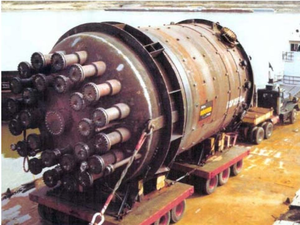
Figura II. 1 – Vaso de pressão fabricado em Aço Ferrítico 2,25Cr-1Mo [3].
