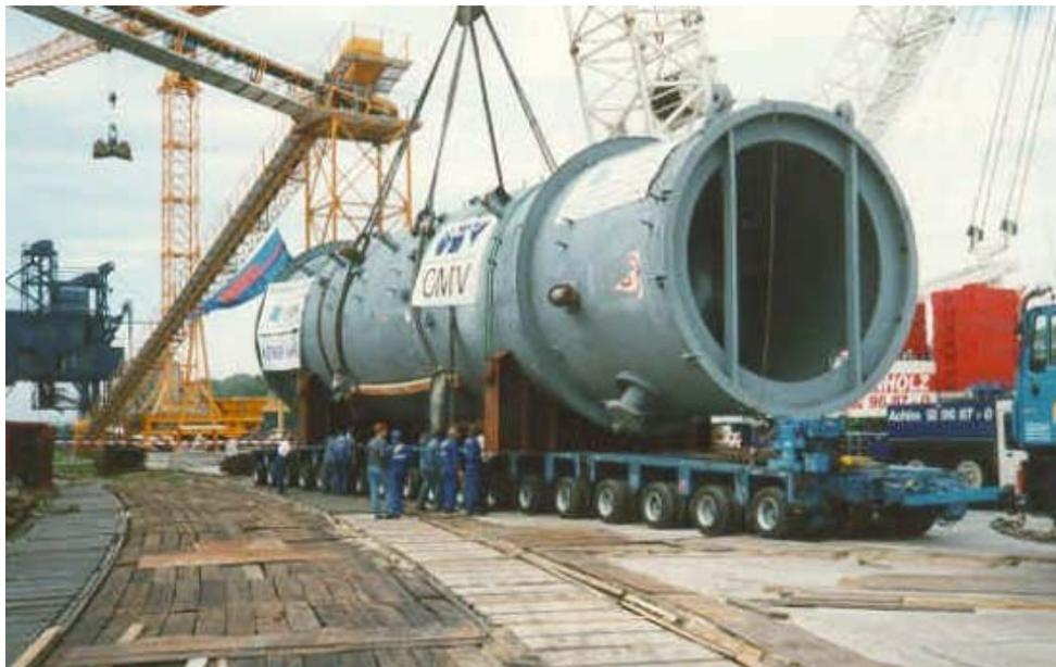
Figura II. 2 – Torre de Craqueamento fabricada em Aço Ferrítico 12Cr-1Mo [4].
