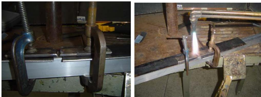
Figura III.4. Detalhe do alinhamento das chapas e pré-aquecimento a 150°C.
