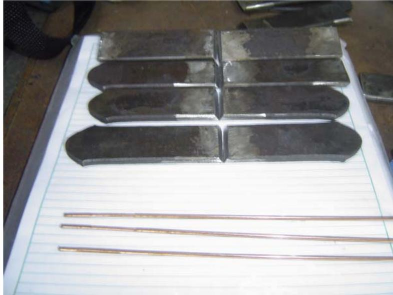
Figura III.3. Detalhe do consumível E90SB3 e das chapas com os chanfros já preparados.
