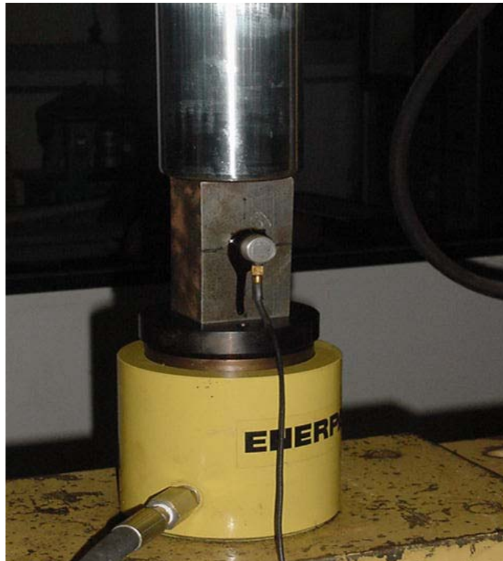
FIGURA 20 – Fotografia do corpo-de-prova sendo comprimido para levantamento da constante acustoelástica
