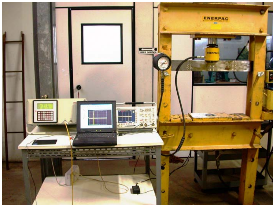
FIGURA 19 – Fotografia do sistema ultra-sônico e da barra sendo submetida à flexão
