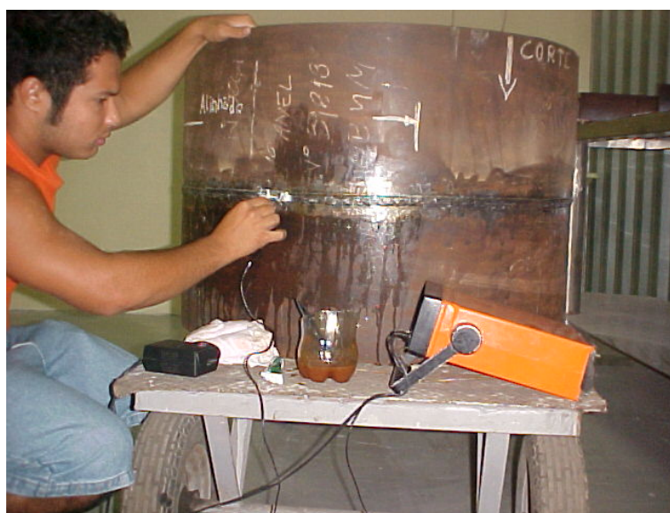
Figura 44: Testes não destrutivos da junta circunferencial (ultra-som).
