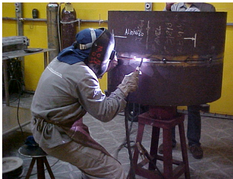
Figura 43: Soldagem do anel, passe de raiz.
