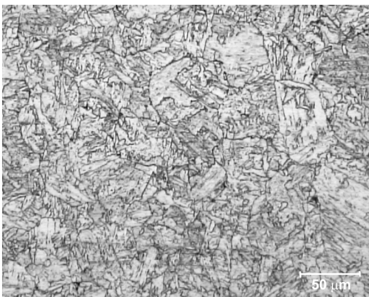
Figura 64: Microestrutura da ZTA próximo do metal da solda (200X).
