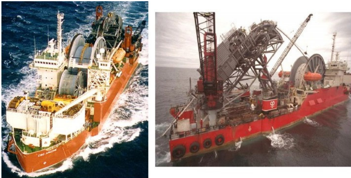
Figura 3: Navio Stena Apache utilizado para lançamento de risers rígidos pelo método reel-lay [6].
