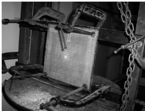
Figura 3.14 - Dispositivo de fixação do alvo.
