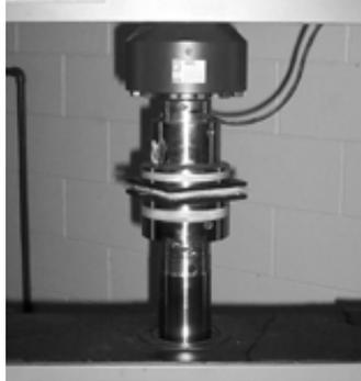
Figura 3.3 - Sistema utilizado para determinação da curva de compressibilidade.
