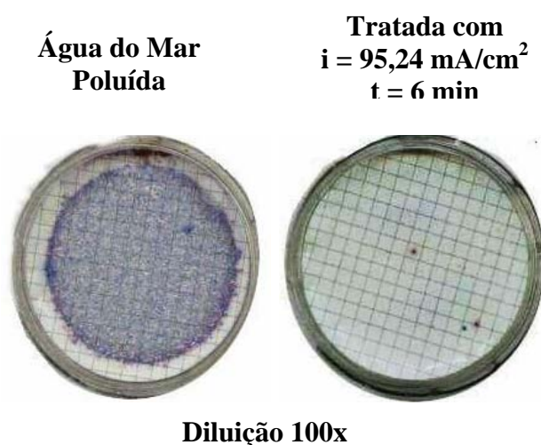
Figura V.11: Aspecto visual das membranas utilizadas na análise microbiológica da água do mar poluída antes e após tratamento com i = 95,24 \text{ mA/cm}^2 , \kappa = 18,6 \text{ mS/cm} e tempo de residência de 6 min.
