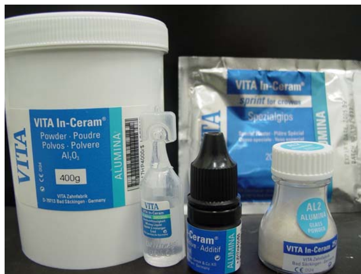
Figura 3- Materiais para confecção do In-Ceram ® Alumina. Da esquerda para direita: pó de alumina, solvente aquoso, aditivo, pó de vidro de lantânio e gesso (ao fundo).
