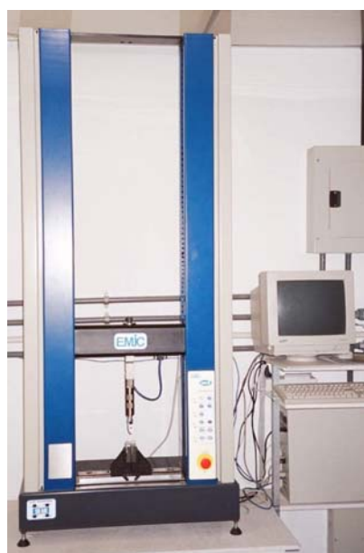
Figura 5- Equipamento de ensaio universal (EMIC linha DL 1000).
