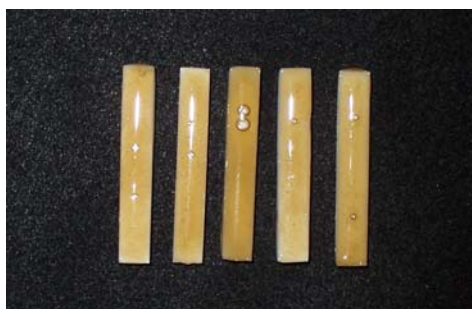
Figura 10- Barras de alumina parcialmente sinterizadas e infiltradas com vidro de lantânio.
