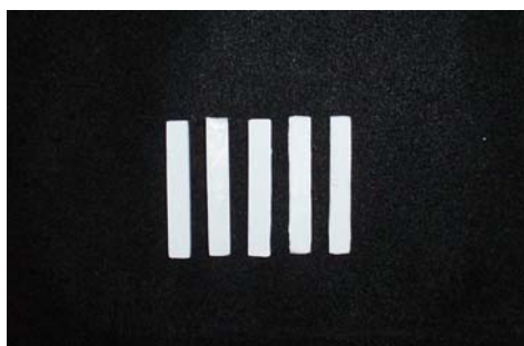
Figura 9- Barras de alumina parcialmente sinterizadas.
