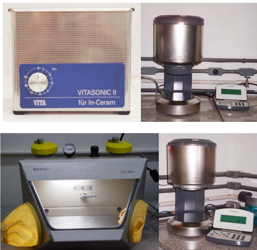
Figura 4- Equipamentos para confecção do In-Ceram ® Alumina. No sentido horário: aparelho de ultrassom Vita Vitasonic ® II, forno de queima Vita Inceramat ® 3, forno de queima Vita Vacumat ® 40 e trijato Easy Blast (Bego).
