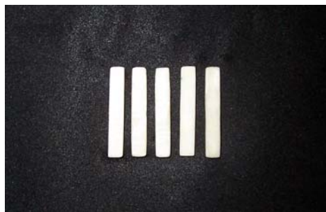
Figura 11- Barras de alumina parcialmente sinterizadas, infiltradas com vidro de lantânio e usinadas.
