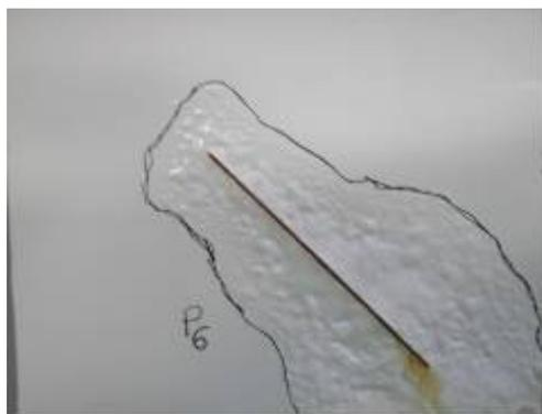
Figura 50: Amostra exposta em campo, após 240 dias. Não apresenta defeitos aparentes. Tinta Poliuretano
