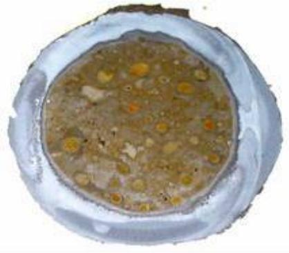
Figura 21: Substrato atacado, após 15 dias de imersão total em NaCl 1%. Tinta Alquídica. A<sub>1</sub>IT
