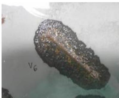
Figura 56: Amostra exposta em campo, após 240 dias. Não apresenta defeitos aparentes. Verniz
