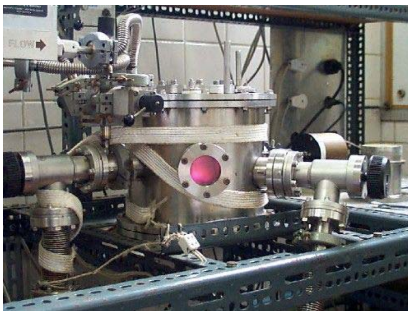
Figura 25 - Câmara de deposição utilizada no recobrimento dos parafusos.
