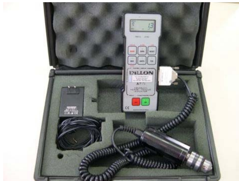
Figura 28 - Torquímetro Digital Dillon® utilizado nos ensaios.
