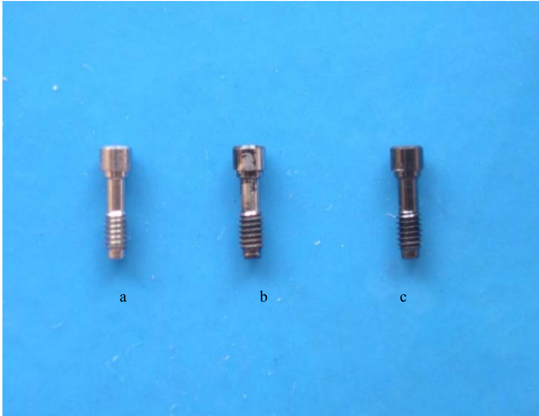
Figura 38 – Aspecto dos parafusos após quinto torque de afrouxamento: (a) sem recobrimento, (b) DLC e (c) DLC-Si.
