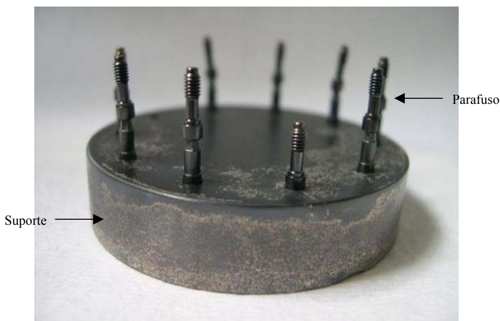
Figura 22 – Suporte utilizado para deposição de carbono amorfo nos parafusos
