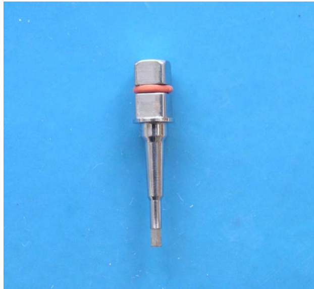
Figura 27 - Chave hexagonal usada para aplicação do torque no parafuso
