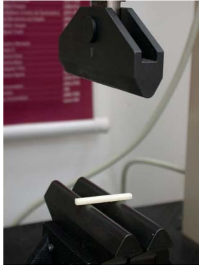
Figura 14 – Posicionamento do corpo de prova para ensaio de flexão
