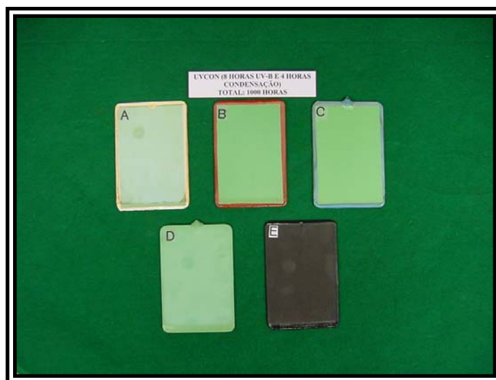
Figura 44 - Aspecto dos corpos-de-prova sem incisão, pintados com esquemas de pintura A, B, C, D, e E, após 1000 horas em ensaio de exposição à radiação ultravioleta (UV-B) e condensação de umidade.
