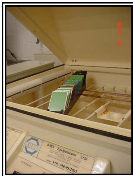
Figura 40 - Equipamento utilizado para o ensaio de exposição contínua em névoa salina.
