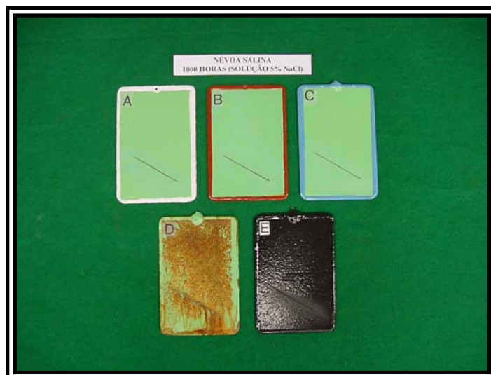
Figura 47 - Aspecto dos corpos-de-prova com incisão, pintados com esquemas de pintura A, B, C, D, e E, após 1000 horas em ensaio de exposição contínua em névoa salina.
