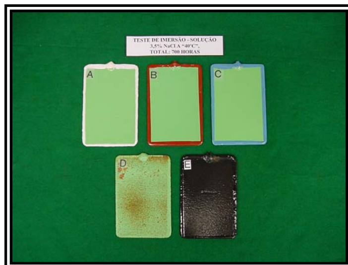
Figura 50 - Aspecto dos corpos-de-prova pintados com esquemas de pintura A, B, C, D, e E, após 700 horas no ensaio de imersão em solução de NaCl a 3,5%.
