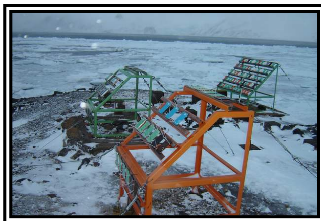
Figura 34 - Estação de Corrosão Atmosférica instalada na Estação brasileira na Antártica.
