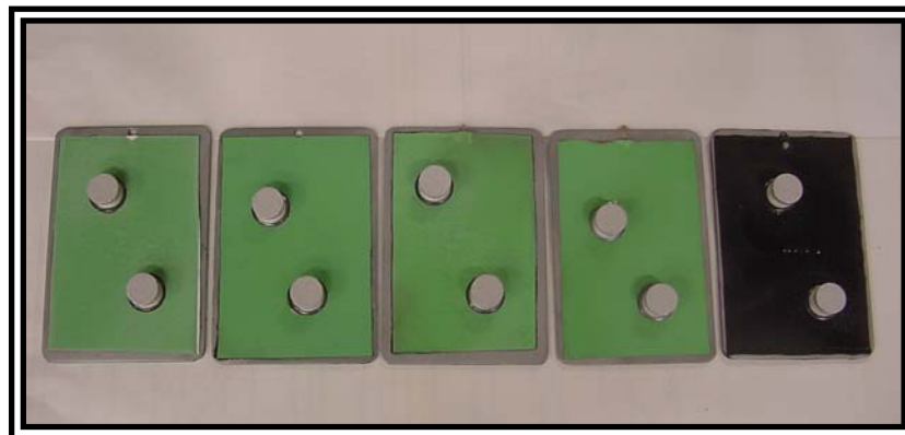
Figura 41 - Corpos-de-prova com os esquemas de pintura A, B, C, D e E, já com os carretéis destinados ao ensaio de aderência.
