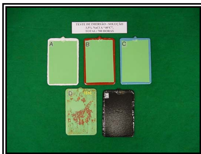
Figura 51 - Aspecto dos corpos-de-prova, pintados com esquemas de pintura A, B, C, D, e E, após 700 horas no ensaio de imersão em solução de NaCl a 3,5%.
