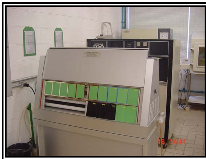
Figura 39 - Equipamento utilizado para o ensaio de exposição à radiação ultravioleta (UV) e condensação de umidade.
