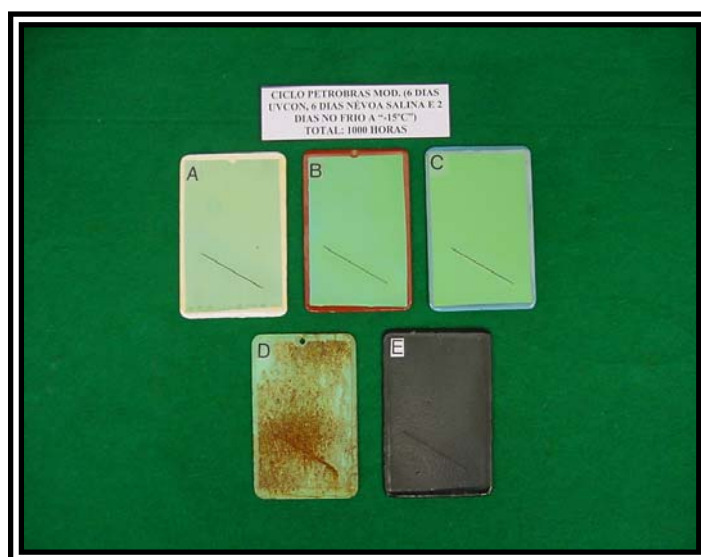
Figura 49 - Aspecto dos corpos-de-prova com incisão, pintados com esquemas de pintura A, B, C, D, e E, após 1000 horas no ensaio ciclo Petrobras modificado.
