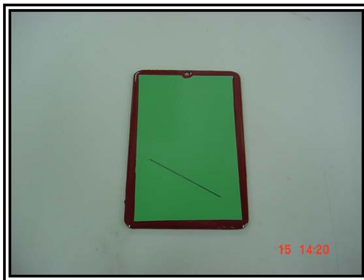
Figura 32 - Aspecto da incisão em um corpo-de-prova, pintado com o esquema de pintura denominado B.
