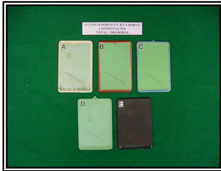
Figura 45 - Aspecto dos corpos-de-prova com incisão, pintados com esquemas de pintura A, B, C, D, e E, após 1000 horas em ensaio de exposição à radiação ultravioleta (UV-B) e condensação de umidade.
