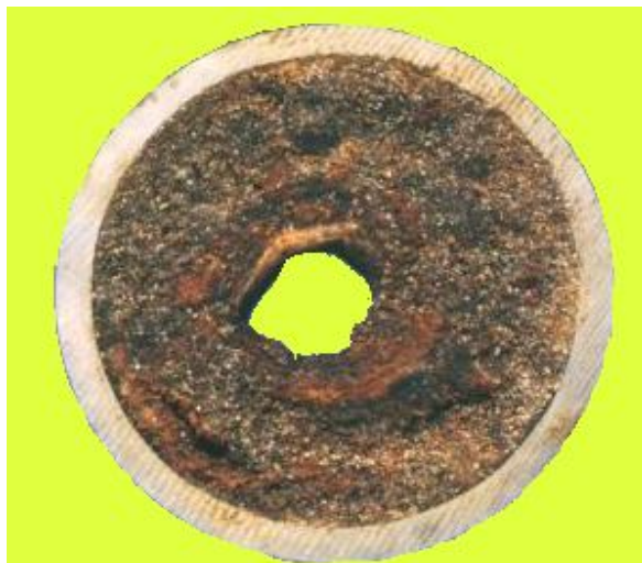
Figura 1 – Fotografia da deposição da parafina no duto [9].
