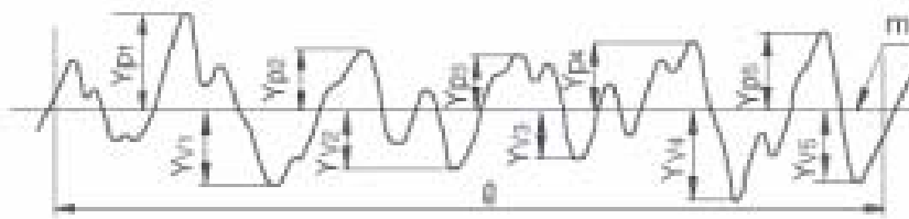
Figura 11- Ilustração do parâmetro de rugosidade R_z [45]
