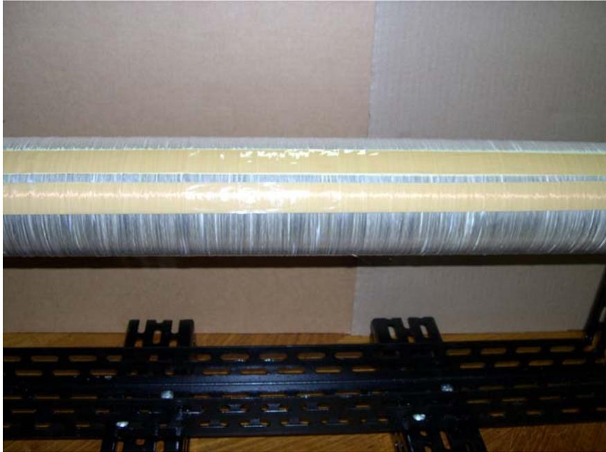
Figura 3.3: Camada de fibra de vidro após o término do enrolamento ao longo de todo o cilindro com aplicação das fitas adesivas.
