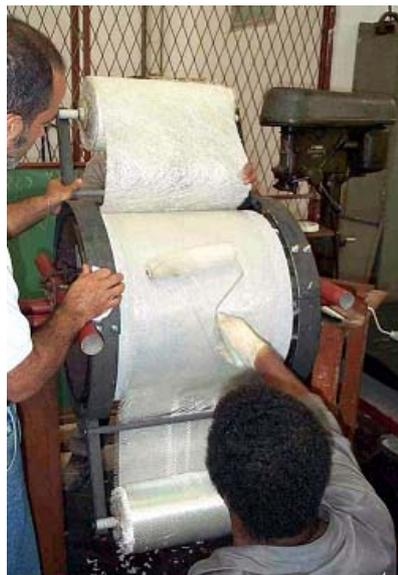
Figura 2.29: Reparo com compósitos através de laminação *in situ* [22].
