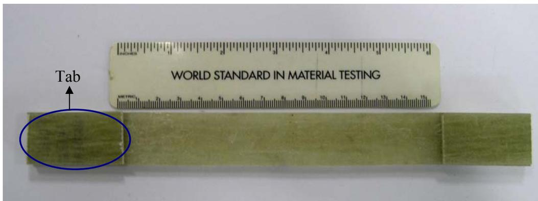
Figura 3.9: Corpo de prova de compósito obtido a partir do corte do laminado.
