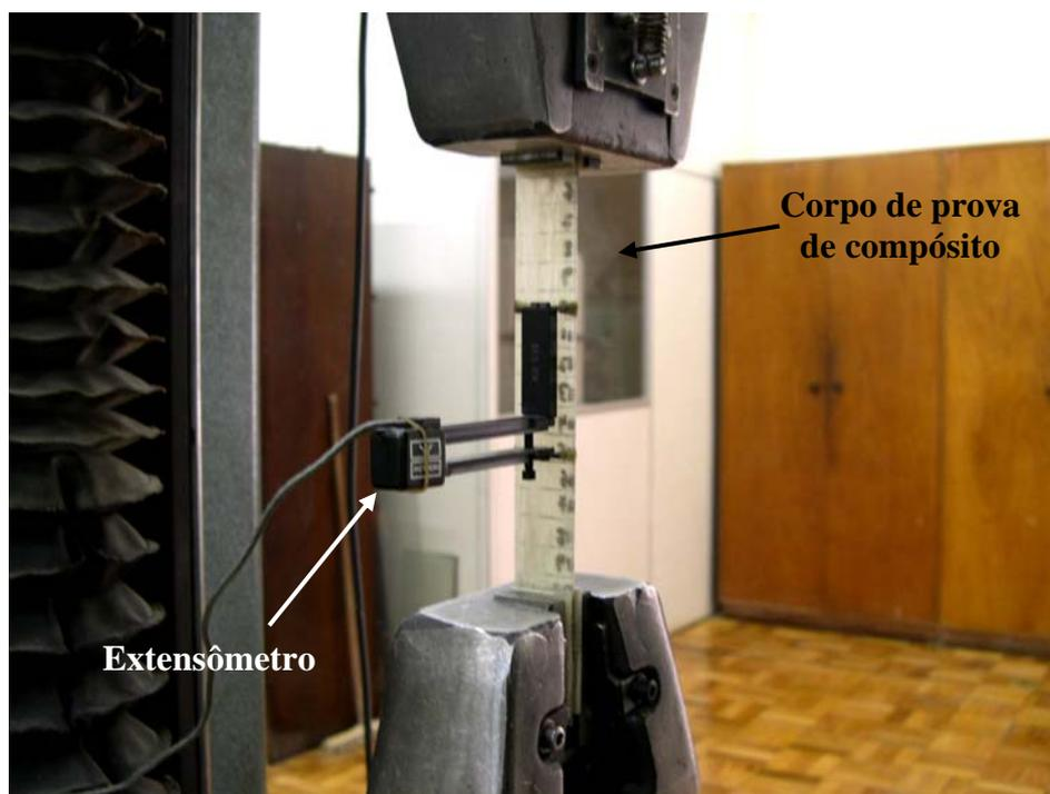
Figura 3.7: Posicionamento do corpo de prova de compósito durante ensaio de tração.
