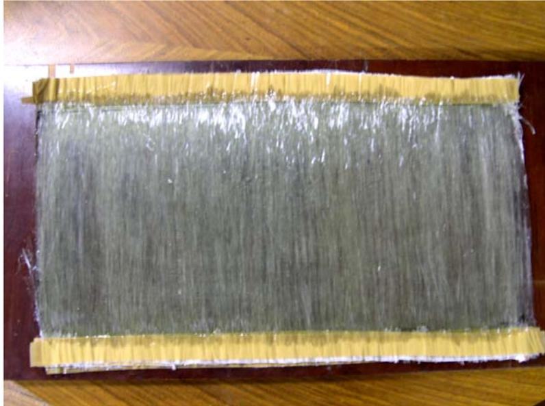
Figura 3.5: Placa de compósito resultante do processo de laminação manual após cura a temperatura ambiente.
