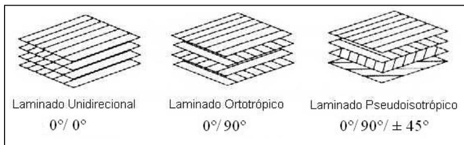
Figura 2.10: Laminados com diferentes sequências de laminação [30].
