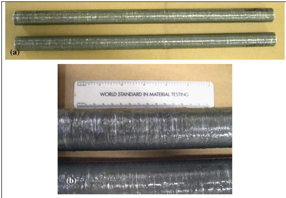
Figura 3.16: Tubos de aço após receber reforço de material compósito: (a) visão geral dos tubos; (b) detalhe da superfície.
