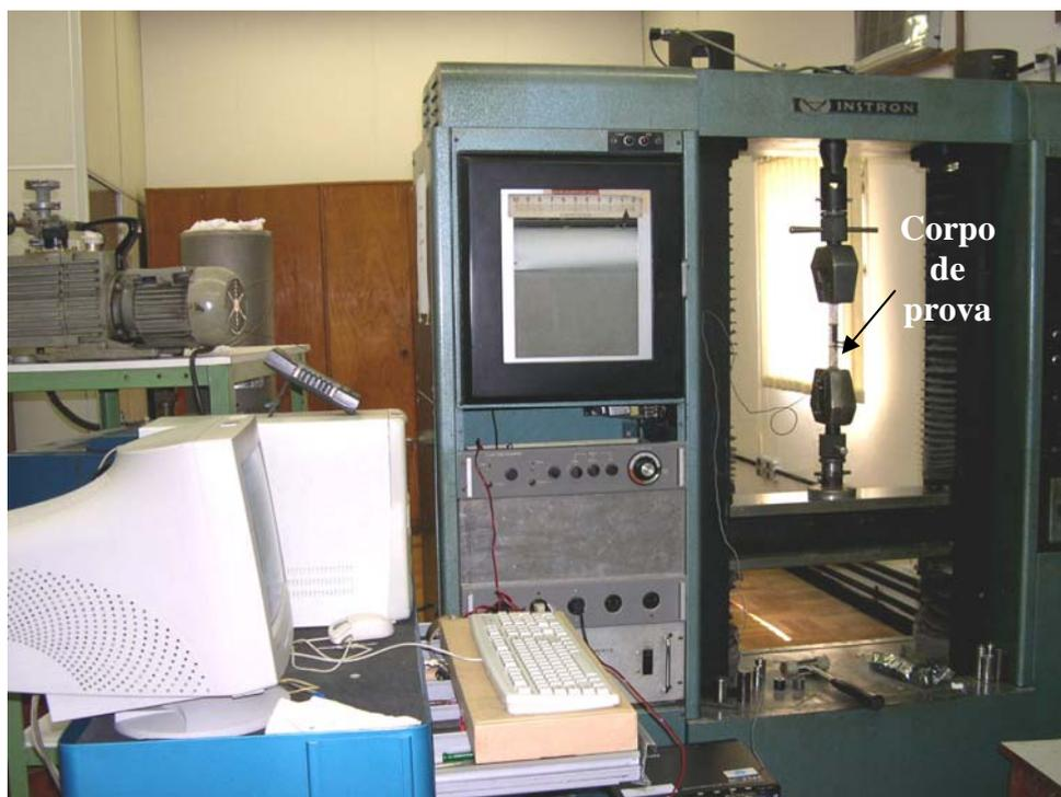
Figura 3.6: Equipamento utilizado no Ensaio de Tração.
