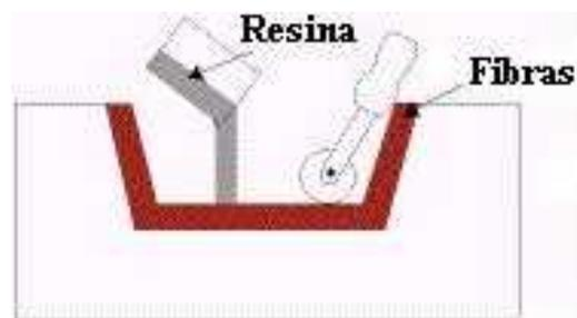
Figura 2.9: Procedimento de fabricação de materiais compósitos por laminação manual [27].
