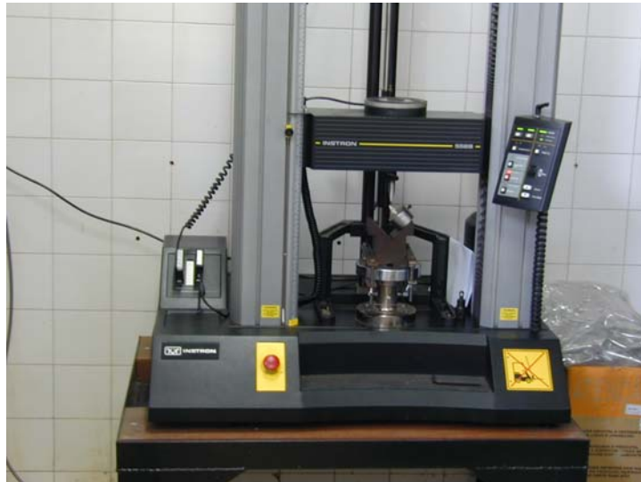
Figura 12: Equipamento utilizado para os ensaios mecânicos com o dispositivo de posicionamento dos dentes.
