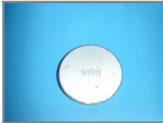
**Figura 49** – Peso de 100 g utilizado no microdurômetro Vickers.
