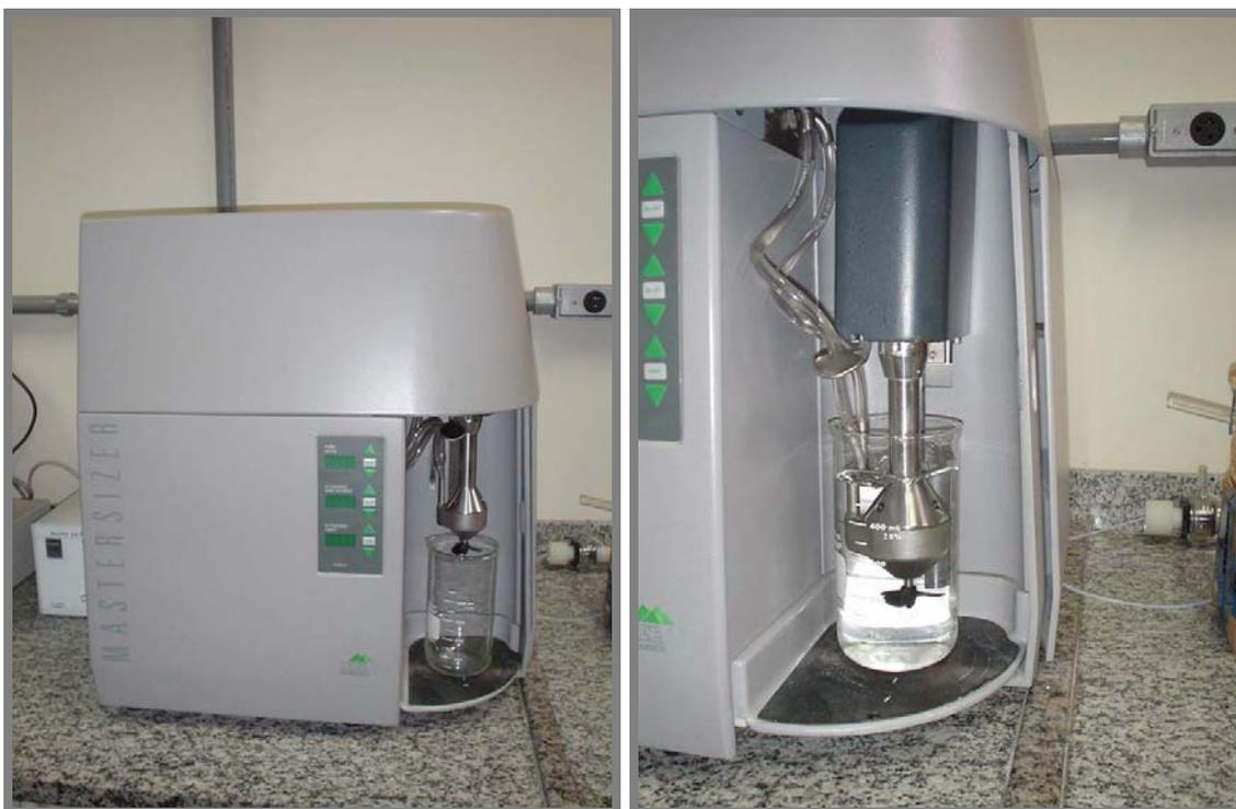
**Figura 47** – (a) Equipamento *Malvern Mastersizer Micro "Plus", MAF 5001*. (b) Visão mais aproximada da água com o pó do material a ser analisado, no Becker.
