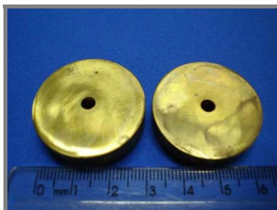
**Figura 50** – Foto dos dispositivos metálicos para o acabamento e polimento das amostras para o ensaio à compressão.
