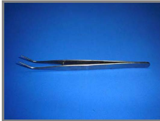
**Figura 31** – Pinça para se manipular as amostras já curadas.
