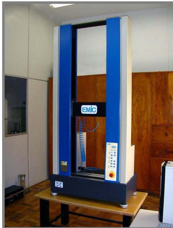
**Figura 57** – Máquina EMIC onde foram realizados os ensaios de tenacidade à fratura.
