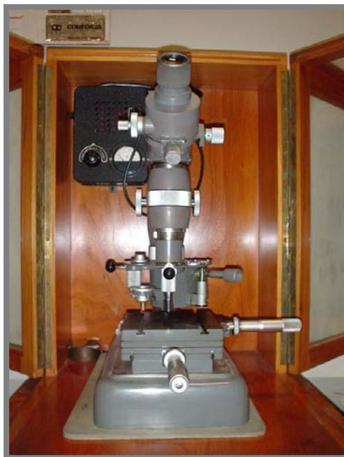
**Figura 48** – Microdurômetro Vickers.
