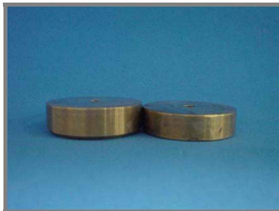
**Figura 52** – Foto da altura diferenciada dos dois dispositivos de acabamento e polimento utilizados para a amostra de ensaio à compressão.
