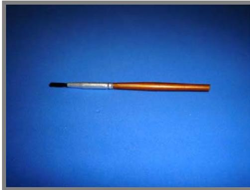
**Figura 24** – Pincel utilizado para a aplicação do isolante nos moldes de acrílico.
