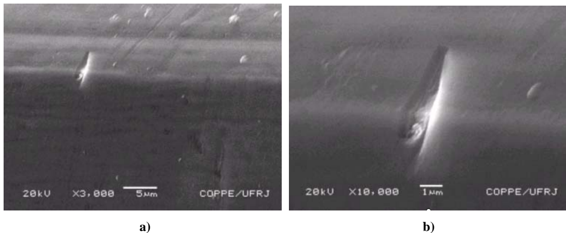
Figura 5.10: Deslocamento ocorrido nas bordas das amostras de aço inox recobertas com DLC por 2 horas e -200 V: (a) aumento de 3.000x e (b) aumento de 10.000x.
