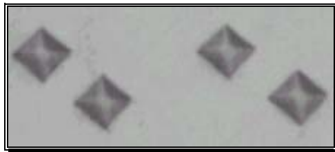
Figura 4.2: Fotografia das penetrações Vickers com cargas de 15g em amostra de aço inox com aumento de 500 x.
