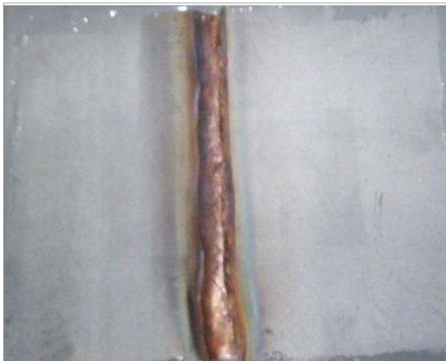
Figura III. 6 – Corpo de prova para ensaio de corrosão em câmara de névoa salina.
