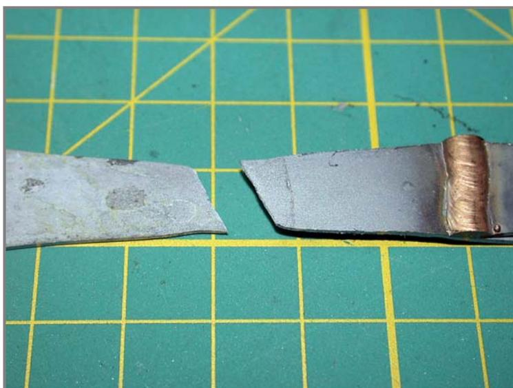
Figura IV. 4 – Detalhe do corpo de prova utilizado no ensaio de tração.
