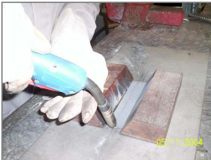
Figura III. 9 – Suporte utilizado durante a brasagem dos corpos de prova.
