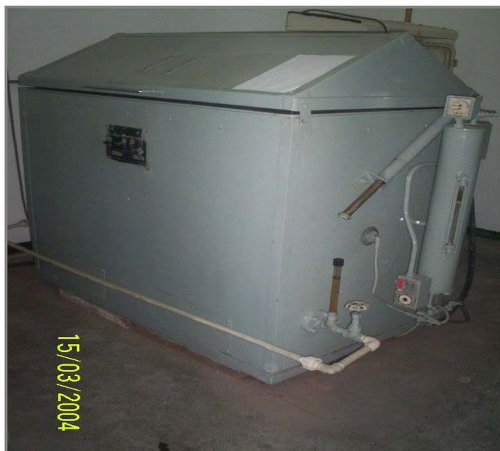
Figura III. 3 – Câmara de névoa salina.
