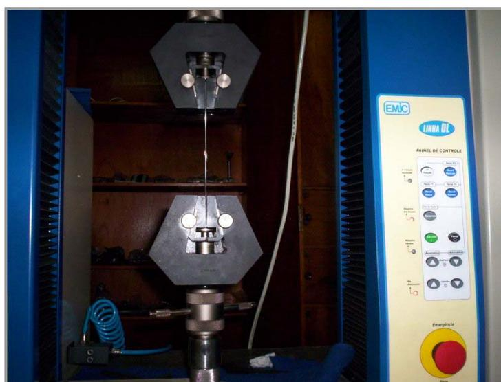
Figura III. 2 – Detalhe do corpo de prova posicionado para o ensaio da tração.
