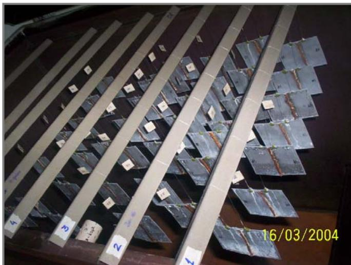
Figura IV. 10 – Disposição das amostras no interior da câmara de névoa salina.
