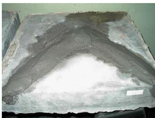
**Figura III.2 - Pastilha coberta com massa similar ao do concreto do CP de modo a fechar o circuito da proteção catódica. O “V” invertido feito com massa é o cobrimento dos 2 arames de ligação da pastilha com a armadura.**
