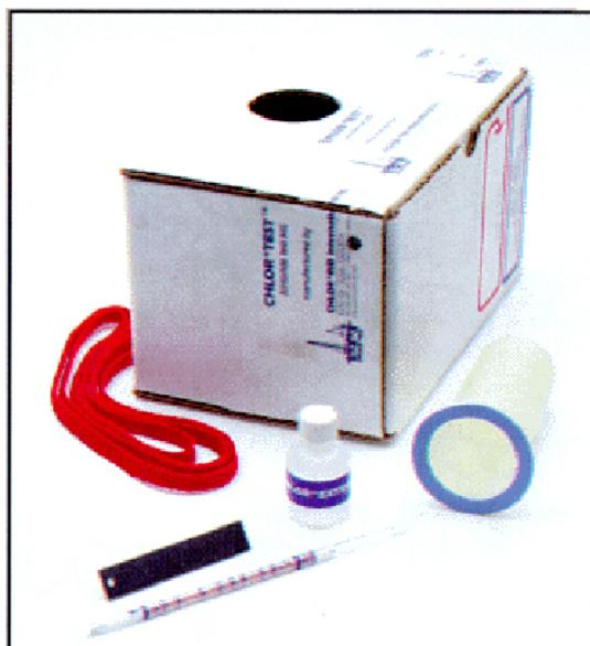
*Figura III. 3.1. - Sistema de medição CHLOR – TEST utilizado nas medições dos teores de Cloretos. Observa-se o frasco com o reagente, a sonda de titulação e o suporte plástico.*
