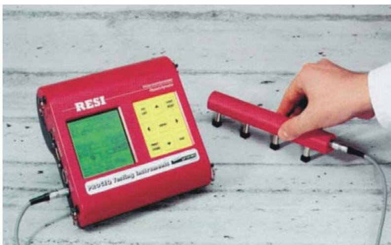
*Figura IV.1 – Equipamento RESI utilizado na obtenção dos valores da resistividade*
