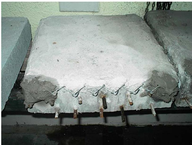
**Figura III.4 - Tela Galvânica instalada no corpo de prova. Nas extremidades do corpo de prova foram feitas as ligações com a armadura e coberto com argamassa.**
