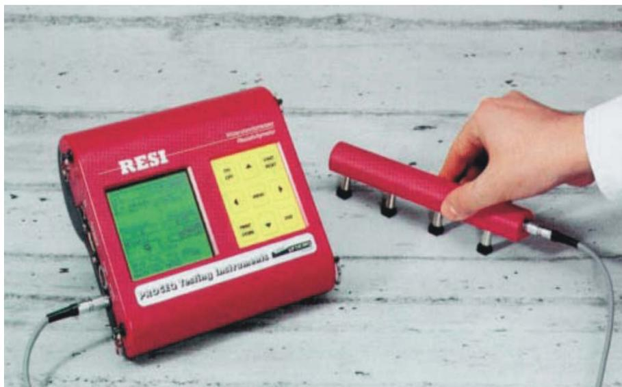
*Figura III.5 - Medidor da resistividade do concreto - RESI.*
