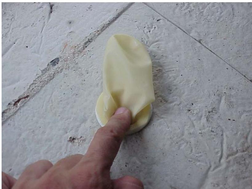
*Figura III. 3.3. - Sistema de medição CHLOR – TEST o reagente, dentro do “suporte”, é esfregado na superfície da estrutura a ser inspecionada, recolhendo-se, posteriormente, o suporte com o líquido para medição.*
