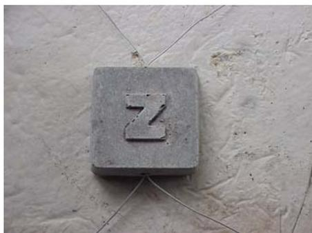
**Figura III.1 - A pastilha galvânica composta por argamassa cimentícia ionizada com sal de lítio e que envolve o anodo de sacrifício em forma de disco preso aos arames.**
