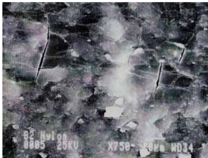
Figura 4.11 – Imagens de MEV de trincas no revestimento de poliamida 11 de um riser após longo período de operação (CHANG et al. , 2001).
