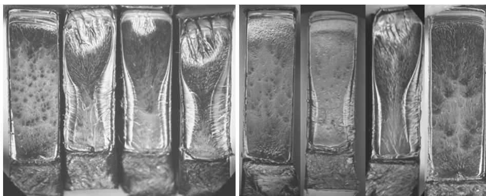
Figura 4.43 – Imagens feitas em lupa da superfície de fratura da poliamida 11. Da esquerda para a direita, amostra não envelhecida, envelhecida 1 dia, 4 dias, 14 dias em água e 1 dia, 4 dias, 14 dias e 24 dias em óleo.
