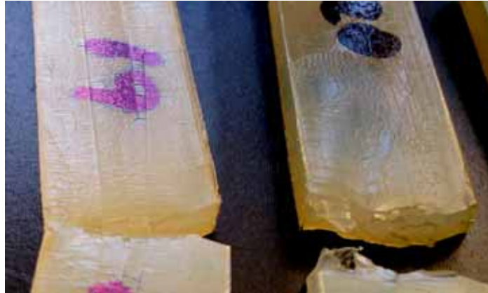
Figura 4.10 – Imagens das trincas superficiais presentes nos corpos de prova de impacto das amostras de poliamida 6 envelhecidas por 14 dias em água.
