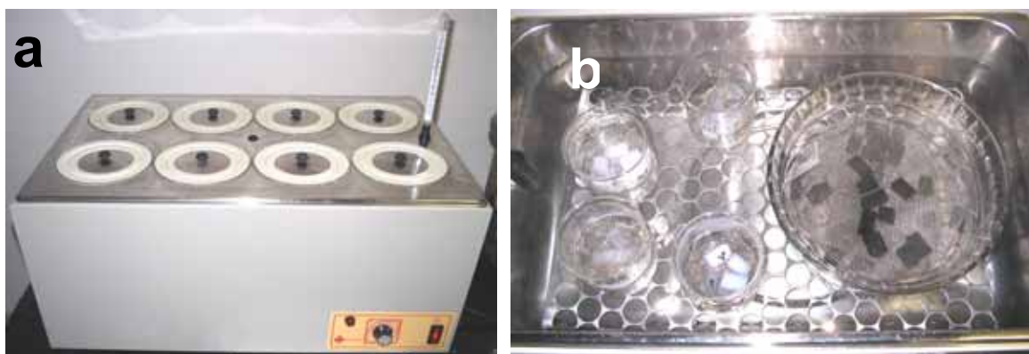
Figura 3.2 – (a) Banho termostático e (b) disposição das amostras dentro do banho.
