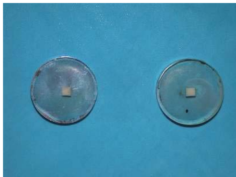
Fig. 34 Amostras dos modelos 1 e 2 seccionados transversalmente embutidos em resina epóxi
