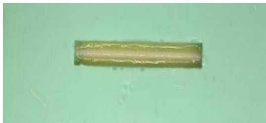
Fig. 30 Aplicação de Artglass , barra e fibras em cordão, segundo modelo 2
