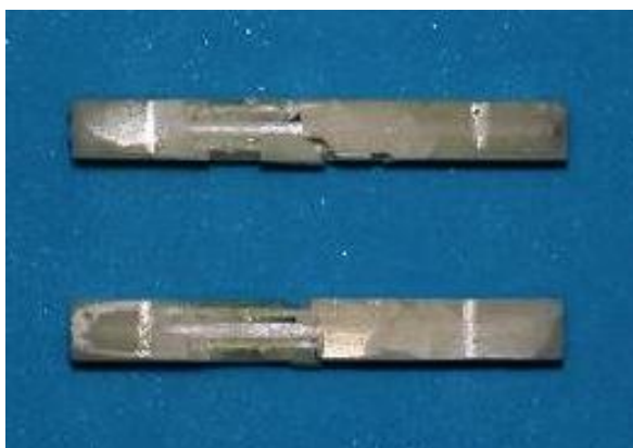
Fig. 59 Vista basal dos corpos de prova do modelo 2 mostrando a perda de pequenos fragmentos da matriz
