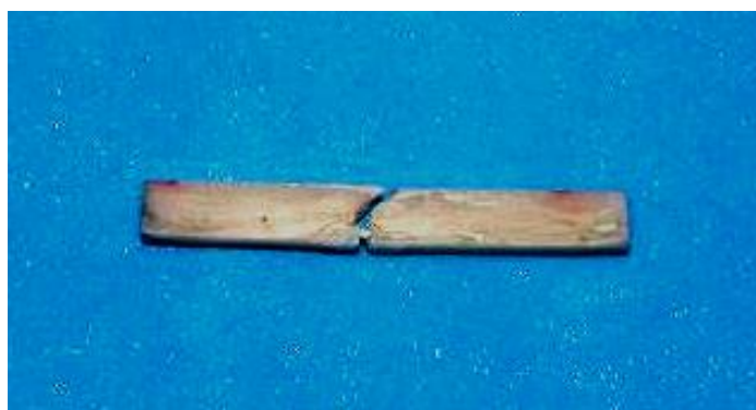
Fig. 57 Corpo de prova do modelo 1 cujas porções fraturadas mantiveram-se unidas por intermédio da fibra
