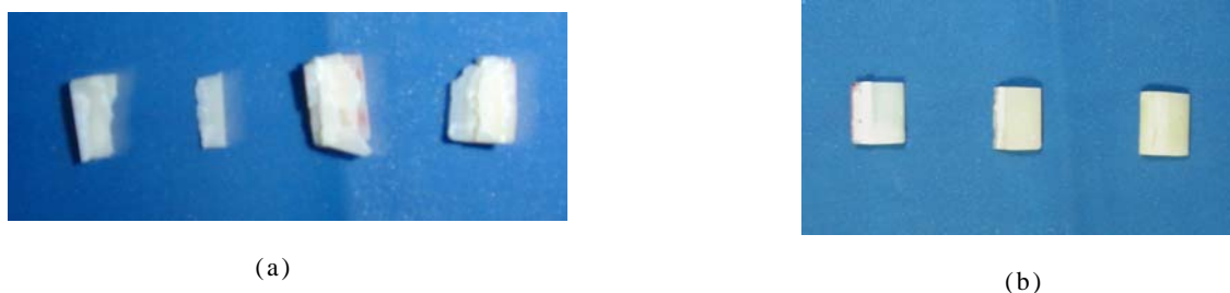
Fig. 53 Corpos de prova dos modelos 1 (a) e 2 (b) após ensaio de compressão. O modelo 2 apresenta um padrão de fratura, ao passo que o modelo 1 foi destruído em pequenos fragmentos isolados
