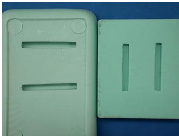
Fig. 23 Moldes fabricados em silicona industrial para confecção dos corpos de prova
