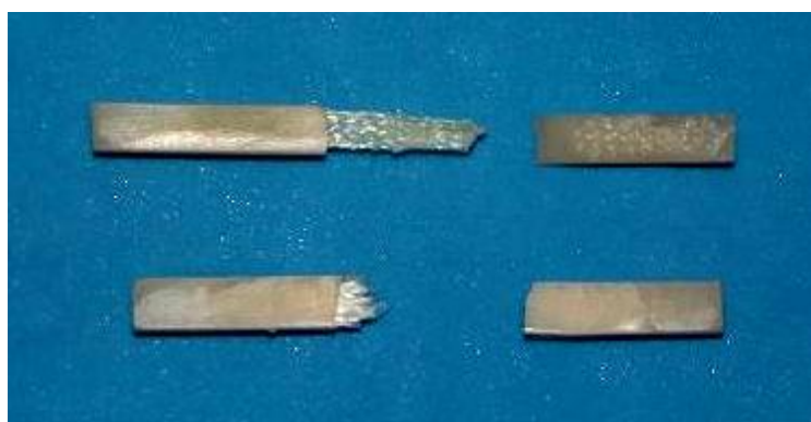
Fig. 58 Corpos de prova do modelo 1 após ensaios de resistência à flexão. Superior: a fibra se soltou completamente de uma das partes fraturadas. Inferior: a fibra também se partiu juntamente com a matriz
