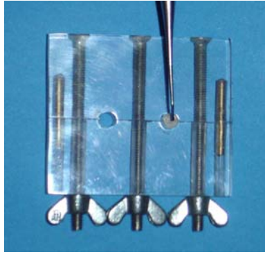
Figura 10 – Molde sendo preenchido com os materiais.
