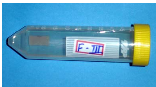
Figura 21 – Amostra imersa na saliva artificial.
