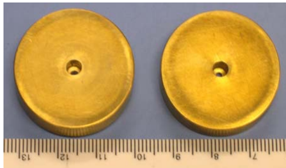
Figura 15 – Foto do dispositivo desenhado para acabamento e polimento das amostras para o ensaio de compressão.
