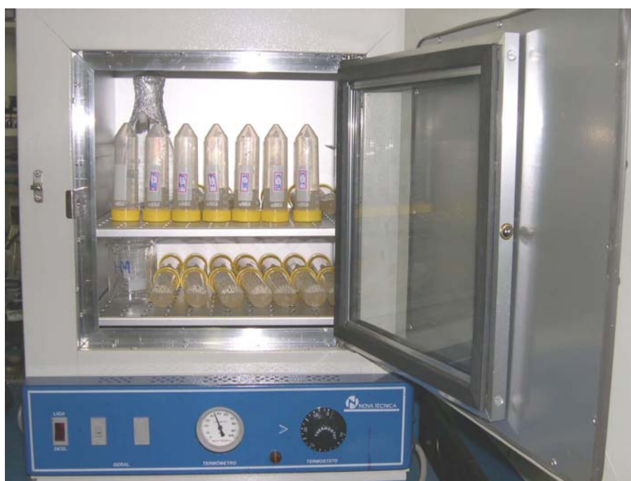
Figura 22 – Foto da estufa com as amostras em seu interior.
