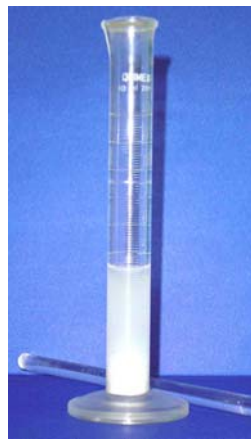
Figura 13 – Amostra macerada imersa em proveta milimetrada para aferição do volume.
