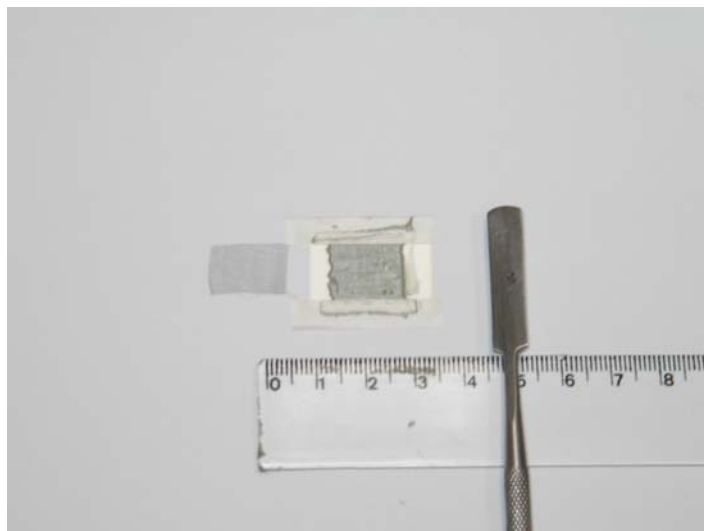
Figura 4.4: Deposição da segunda camada do cermet NiO/YSZ junto a malha de platina.
