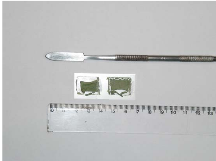
Figura 6.2: Retração do material cermet NiO/YSZ sobre o coletor de corrente de platina.
