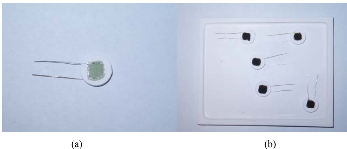
Figura 4.6: Fotografia da pilha a combustível de óxido sólido dos diferentes lados: (a) parte anódica; (b) parte catódica.
