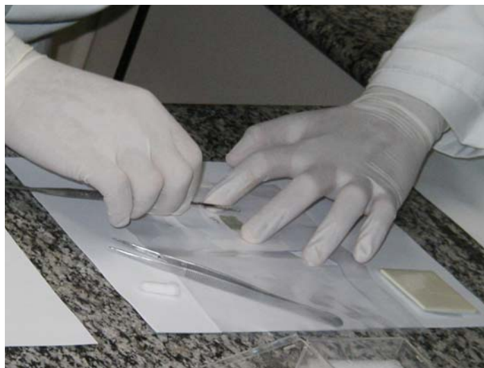
Figura 4.3: Procedimento de deposição da camada do cermet NiO/YSZ para a confecção do eletrodo.
