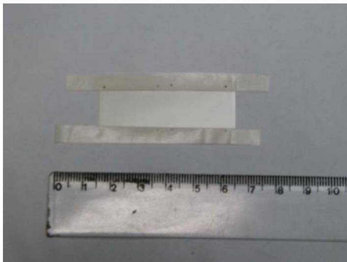
Figura 4.1: Zircônia estabilizada com 8% em mol de óxido de ítrio manufaturado pela técnica de “tape casting”
