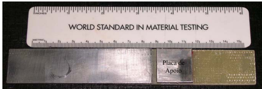
Figura 3.23 – Corpo de Prova com Placa de Apoio.
