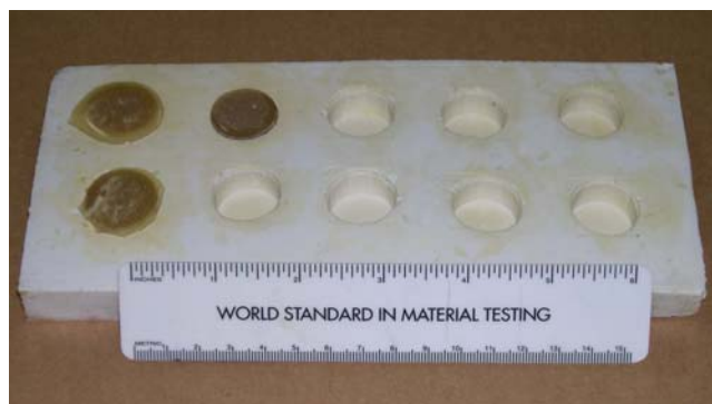
Figura 3.25 – Molde de Silicone para Confeção de Cupons de Adesivo para Envelhecimento.
