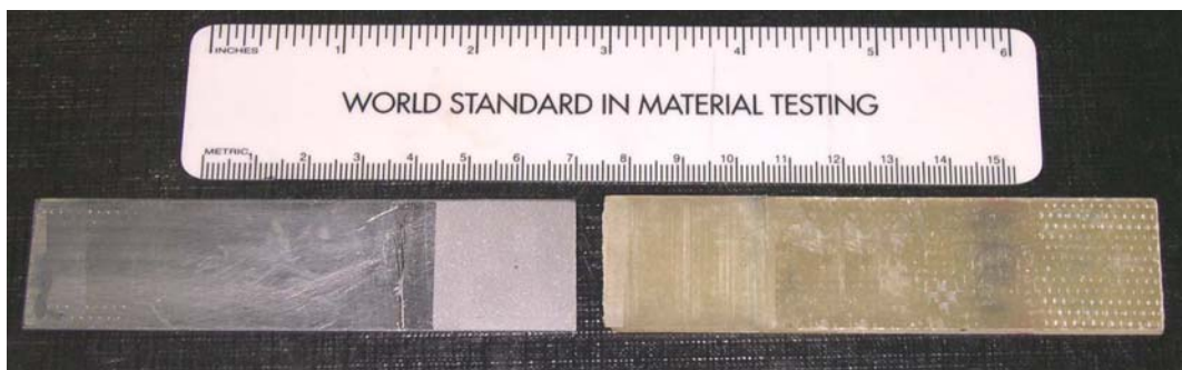
Figura 3.8 – Placas para Confeção das Juntas, Metal Jateado.
