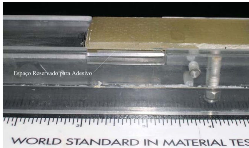
Figura 3.19 - Sistema de Colagem com Placa Jateada Metálica, Espaçador de 0,9 mm e Placa de Compósito.
