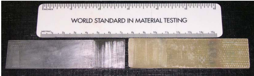
Figura 3.9 – Placas para Confeção das Juntas, Metal Lixado.
