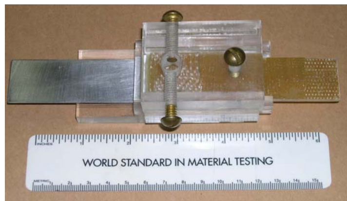
Figura 3.15 - Primeiro Dispositivo de Colagem com as Placas Aderentes.
