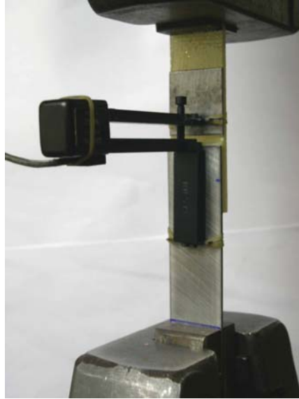
Figura 3.24 – Posicionamento do Extensômetro com Auxílio de Placa Metálica de Apoio.
