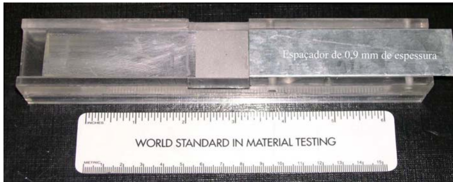
Figura 1.18 - Sistema de Colagem com Placa Jateada e Espaçador de 0,9 mm de Espessura.
