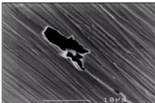
Figura II.24 - Corrosão por pite simulada em aço inoxidável duplex 2205, conforme KOBAYASHI et al. (1999).
