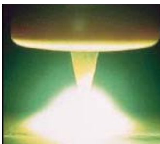
Figura I.3 - Soldagem autógena, sem adição de metal de enchimento, de um aço inoxidável duplex pelo processo TIG.
