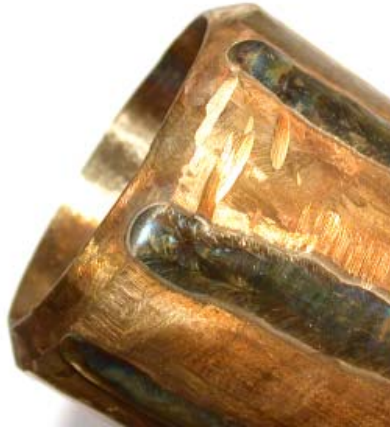
Figura III.3 – Aparência de filetes soldados pelo processo TIG em aço inoxidável duplex.
