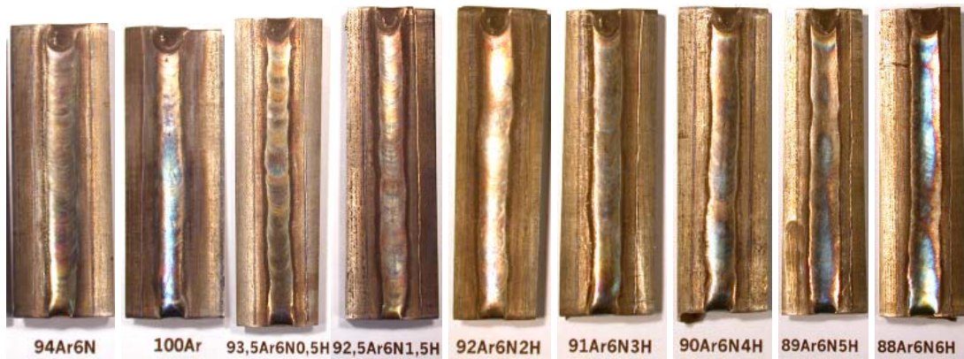
Figura III.5 – Corpos-de-prova cortados na direção longitudinal ao tubo – vista superior.
