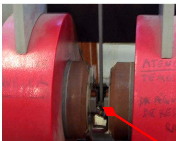
Figura III.11 – Magnetômetro. A seta aponta para a extremidade inferior do condutor e posicionador, onde é posicionada a amostra entre os magnetos.
