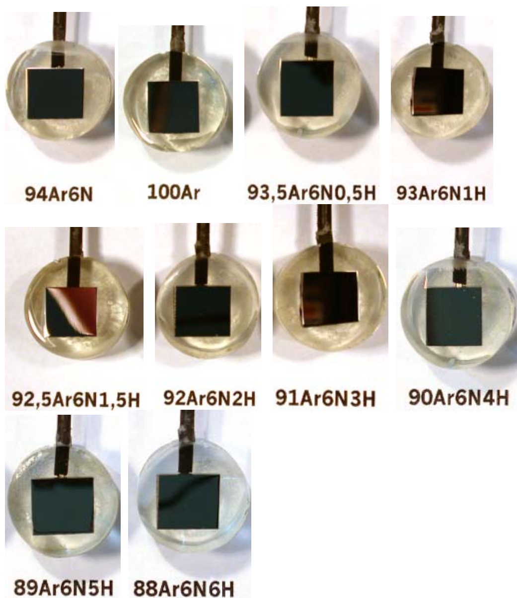
Figura III.13 – Peças preparadas para corrosão por pite.
