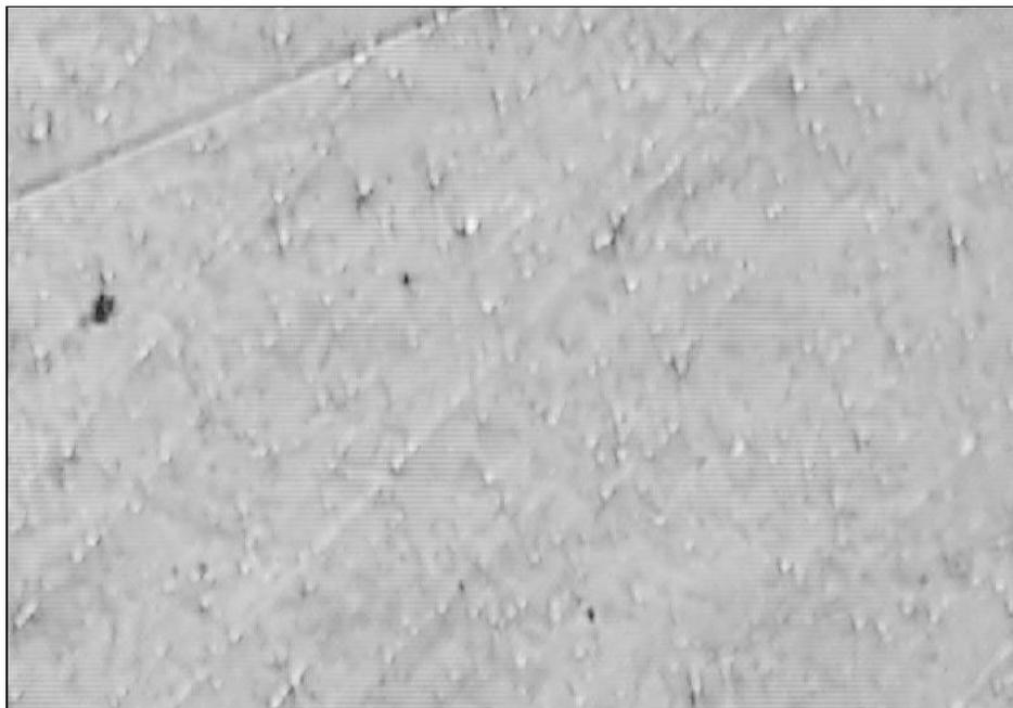
Figura 4.9. Micrografia ótica do aço ASTM A516 gr 60 após ensaio de permeação. Ampliação 50x. As protuberâncias são consequência do arrancamento devido ao lixamento com alumina.
