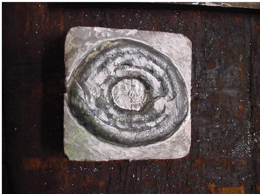
Figura IV.6 – Vista transversal da amostra soldada com  $\text{CO}_2$ , mostrando defeitos por falta de fusão revelados por líquido penetrante (sup.) e corpo-de-prova de trinca a quente da amostra soldada com  $\text{CO}_2$  e arame sólido adicionado a silício (inferior)
