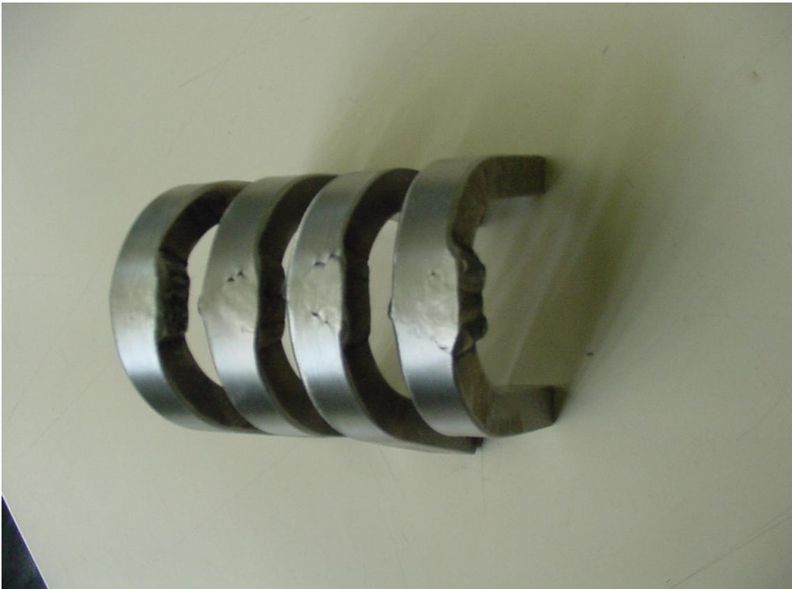
Figura IV.5 – Corpos-de-prova de dobramento das amostras 04, 02, 03 e 09, na ordem, mostrando defeitos na região entre metais de base e de solda
