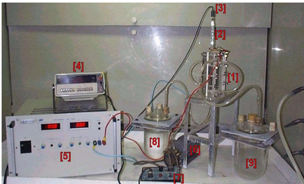
Figura IV.5 – Fotografia do sistema reacional. (1) célula eletrolítica, (2) capilar de Luggin, (3) eletrodo de referência, (4) voltímetro digital, (5) fonte de tensão, (6) bomba peristáltica, (7) controlador da vazão da bomba peristáltica, (8) recipiente de solução para tratamento, (9) recipiente de solução tratada.
