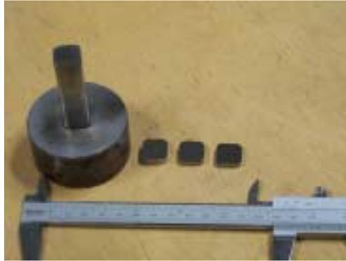
*Figura 3.4 – Aspecto das amostras obtidas por compactação uniaxial utilizando-se matriz quadrada de paredes rígidas.*
