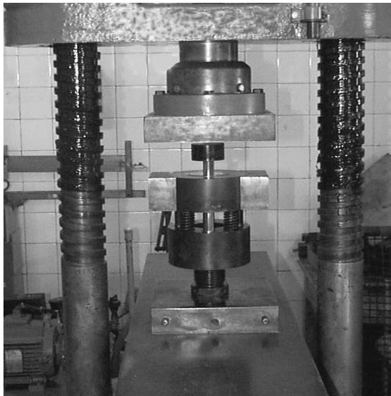
*Figura 3.3 – Prensa hidráulica e matriz uniaxial no momento da compressão.*
