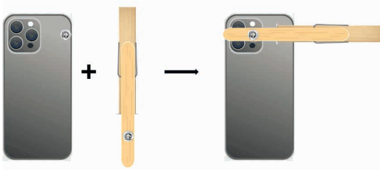
Figura 15.3. Esquema da posição do pregador/palito em relação ao aparelho de telefone celular
