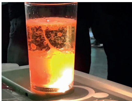
Figura 6.2. Experimento da lâmpada de lava em andamento, com um aparelho celular (com a lanterna acionada) posicionado embaixo do copo.
