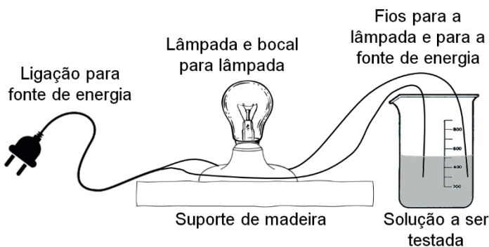
Figura 18.1. Sistema utilizado para testar a condutividade elétrica das soluções.
