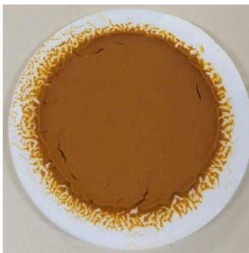
**Figura 39:** Precipitado obtido utilizando  $\text{NH}_4\text{OH}$  como agente precipitante (pH 2,7).
