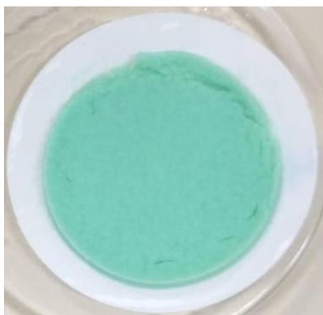
**Figura 43:** Precipitado obtido na segunda etapa de precipitação em pH 3,7 utilizando CaO.
