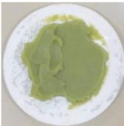
Figura 34: Precipitado obtido durante a precipitação com NaOH como agente precipitante ( $\text{pH} 4$ ).
