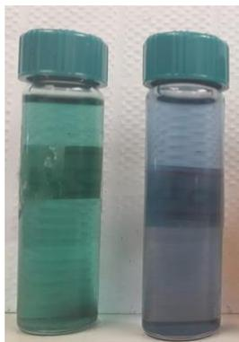
Figura 7.15: Diluição das amostras de PAni.DBSA *in situ* em PVDF-HFP em tolueno e DMF respectivamente, para análise de UV-VIS.
