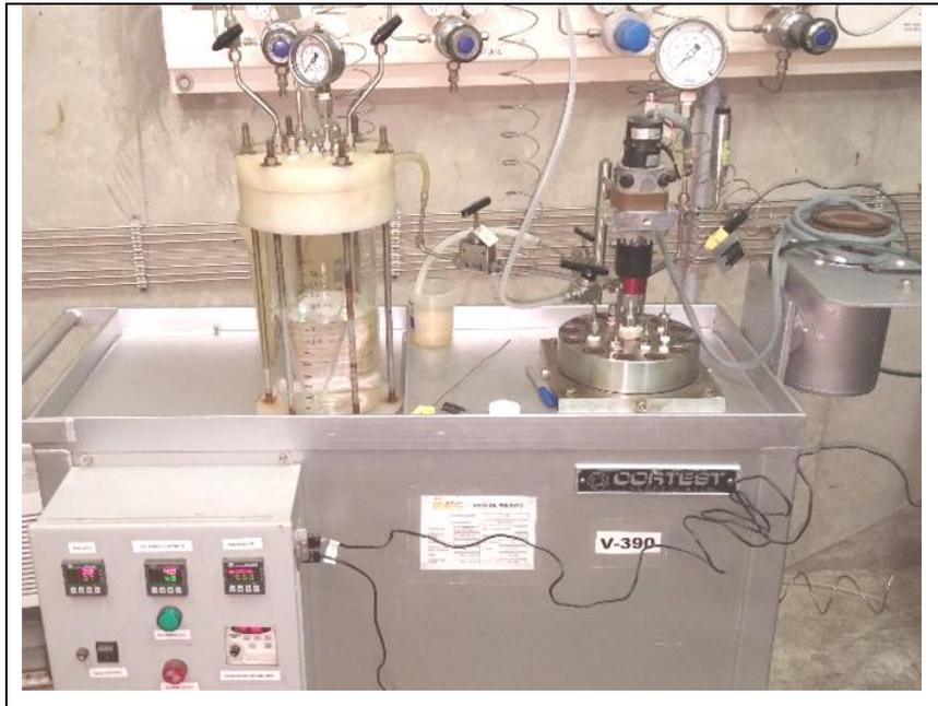
Figura 17: Montagem do sistema de testes. Autoclave completa com entrada e saída de gás, sistema de aquecimento e pressurização.
